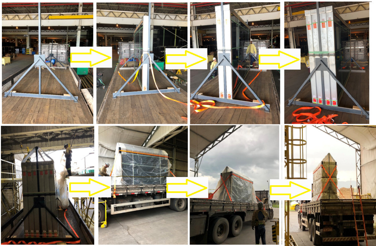
Figura 10 – carregamento AZ RACK®.
