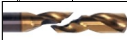
Figura 8 - Amostra quebra em broca
