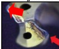
Figura 4 - Desgaste de Cratera
