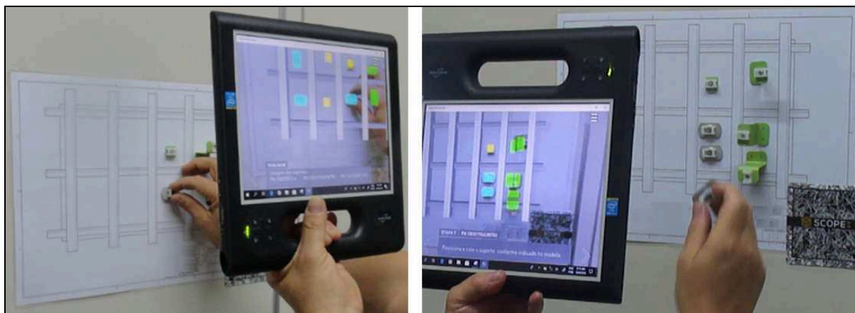
Figura 41 - Operador realizando a montagem utilizando tablet com RA
