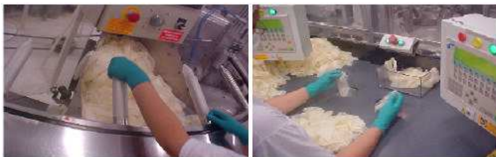
Figura 38 Colocação manual do preservativo no molde e alimentação manual do preservativo na máquina através de um duto de vácuo
