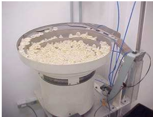
Figura 34 Sistema automático para desenrolar preservativos
