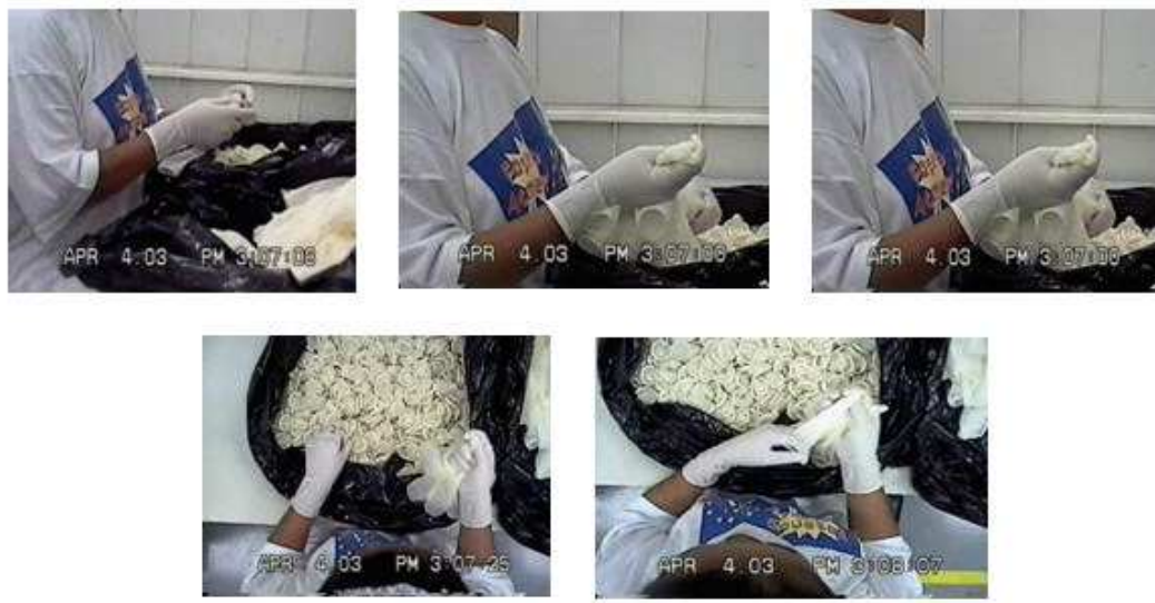
Figura 31 Processo de desenrolar preservativos manualmente
