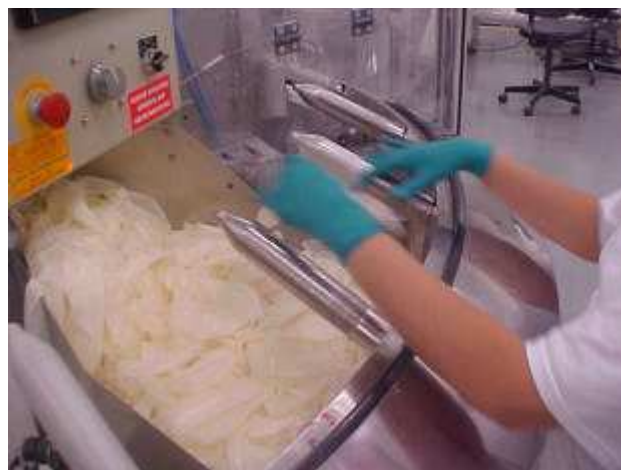
Figura 28 Colocação manual do preservativo no molde
