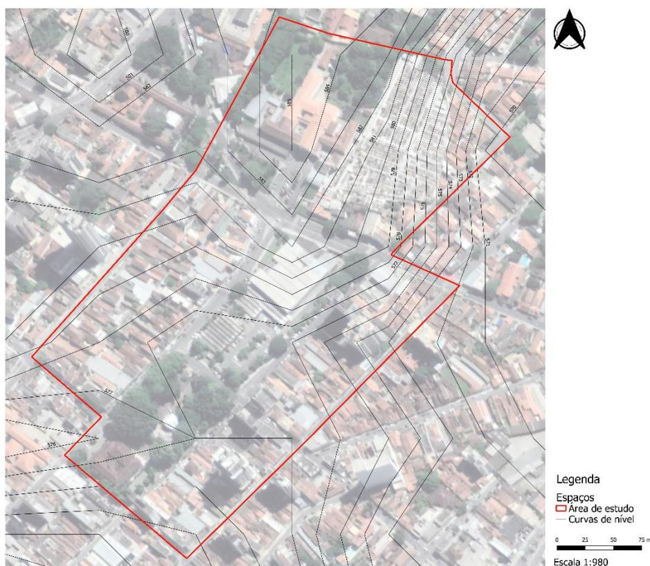
Figura 41 - Mapeamento das curvas de nível da área do Convento.
