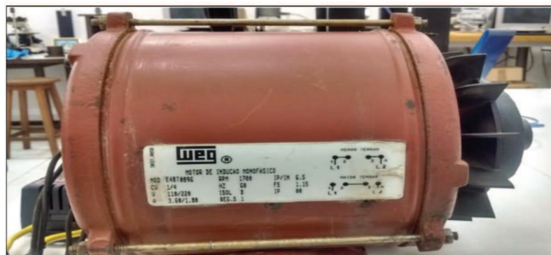
Figura 3.23 - Motor WEG 1/4 CV.
