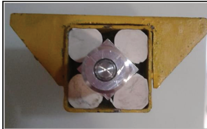
Figura 3.7 - Conjunto de elastômeros montados .
