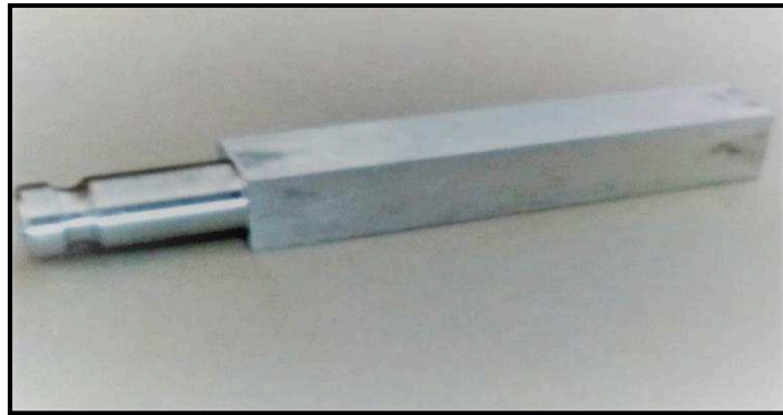
Figura 3.5 - Eixo de torção fabricado.
