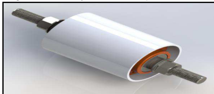
Figura 3.19 - Conjunto montado (Rolete de retorno).
