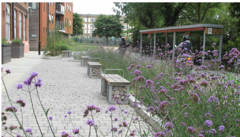
Figura 25 – SuDS: Jardim de chuva, pisos permeáveis e bicicletário com telhado verde. Fonte: SUSDRRAIN, 2014.
