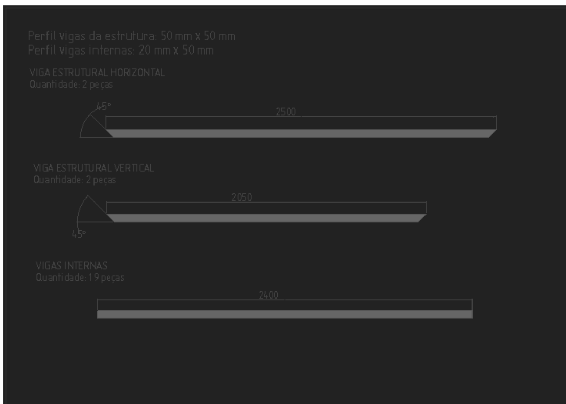
Figura 12 - Portão basculante - Desenho técnico 2D - Folha 2/2
