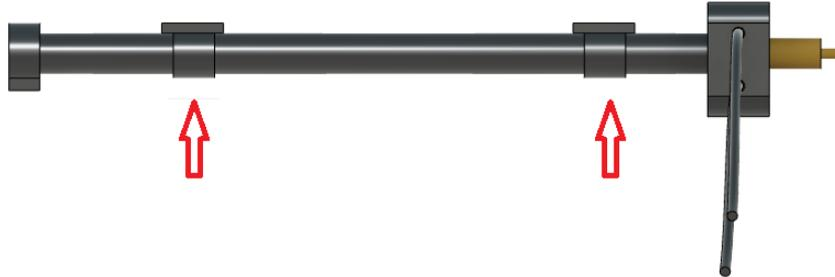
Figura 5 – Detalhe do posicionamento dos bicos de ar
