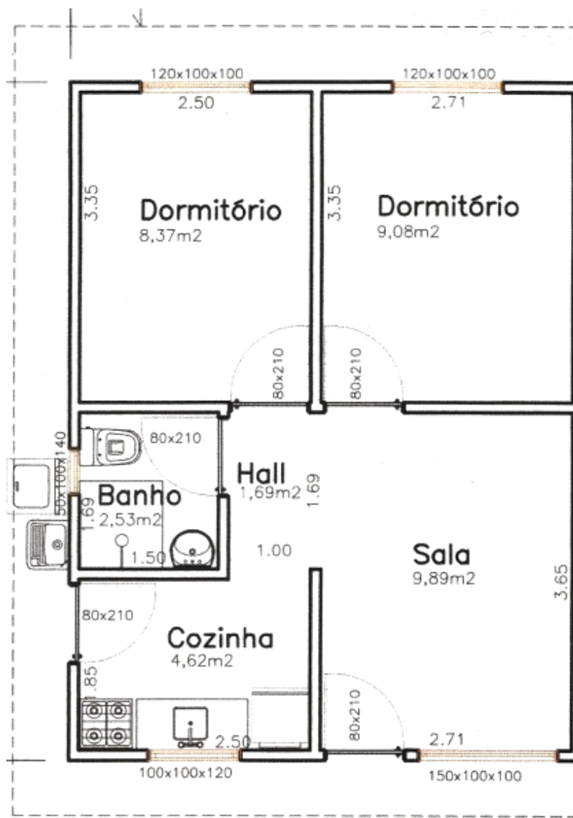
Figura 35: Planta baixa do conjunto estudado, sem escala - Fonte: MM empreendimentos, adaptada pela Autora, 2018;
