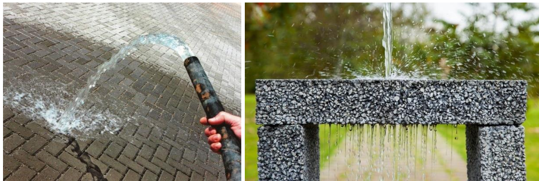
Figura 8 - Exemplos de pavimentos drenantes
