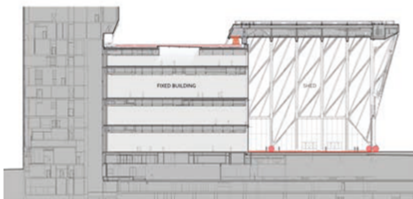
Figura 20 - The Shed - Corte longitudinal da cobertura estendida
