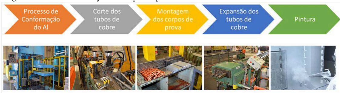
Figura 10 - Fluxo de fabricação dos corpos de prova
