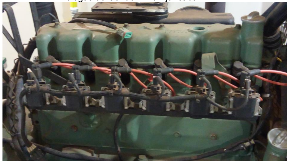
Figura 24 - Motor ciclo Diesel, adaptado com velas e bobinas para operação com biogás do Condomínio Ajuricaba
