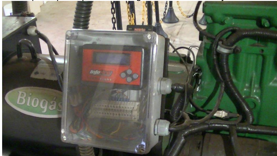
Figura 23 - Sistema eletrônico de controle de ignição para motor ciclo Diesel, adaptado para operar com biogás do Condomínio Ajuricaba
