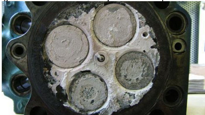
Figura 43 - Válvulas de cabeçote atacadas por siloxanos
