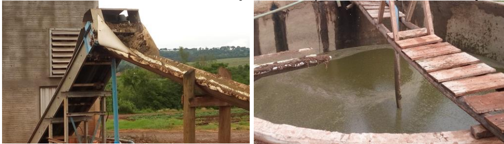
Figura 65 - Esteira de transferência de dejetos e tanque de retenção da Granja Haacke
