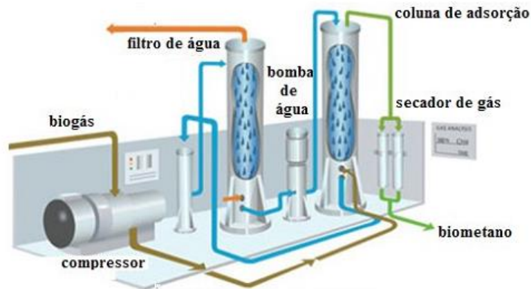
Figura 54 - Desenho esquemático do sistema de purificação Water Scrubbing
