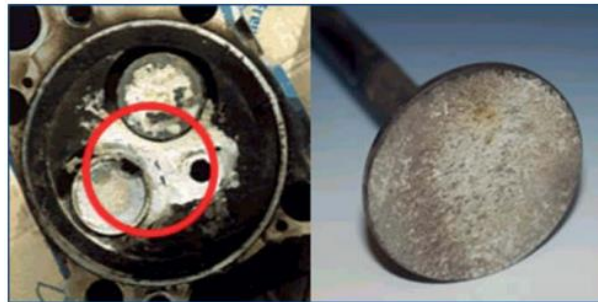
Figura 29 - Depósitos de siloxanos na câmara de combustão do cabeçote
