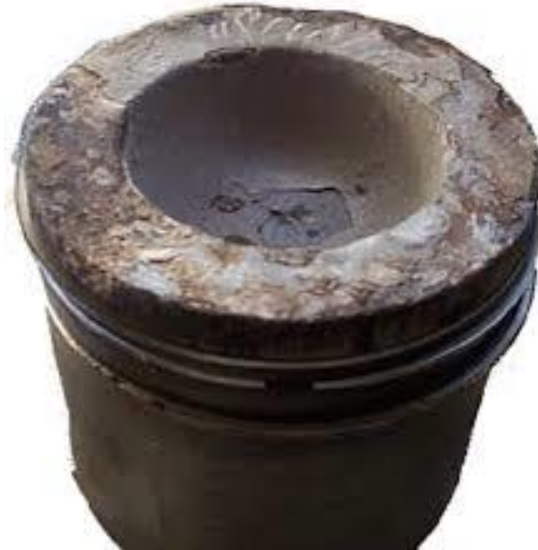
Figura 40 - Pistão com corrosão severa ocasionada por H_2S
