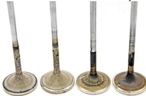
Figura 42 - Válvulas corroídas com utilização de biogás
