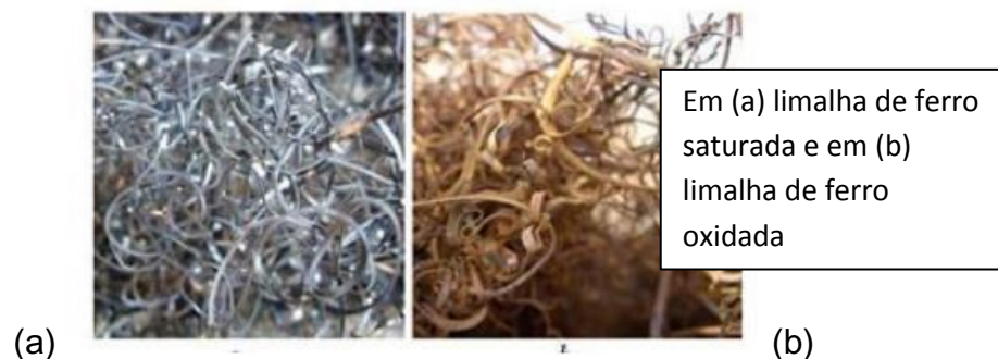
Figura 50 - Saturação da limalha de ferro após tempo de uso
