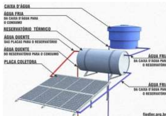
Figura 2 - Sistema de coletor solar
