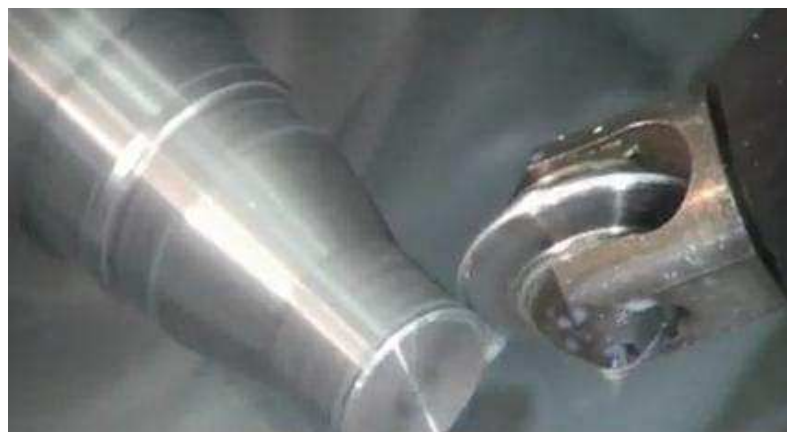
Figura 70: Processo de um rolete atuando em um raio ( www.baublies.de/en/ )
