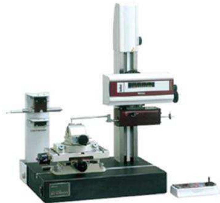
Figura 68: Rugosímetro Formtracer SV-C 3000 S4 ( www.mitutoyo.com.br )
