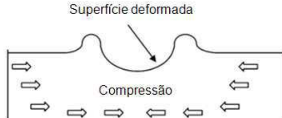
Figura 46: Detalhe da tensão residual superficial após ataque de uma esfera pelo processo de shot peening (adaptada de Meo, 2003)
