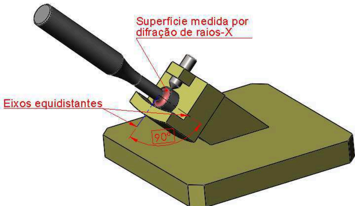
Figura 77: Representação esquemática da fixação do corpo de prova
