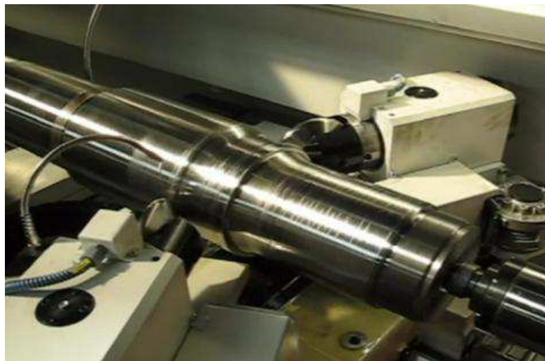
Figura 69: Processo de dois roletes atuando em um raio ( www.kovosvit.cz/en/ )
