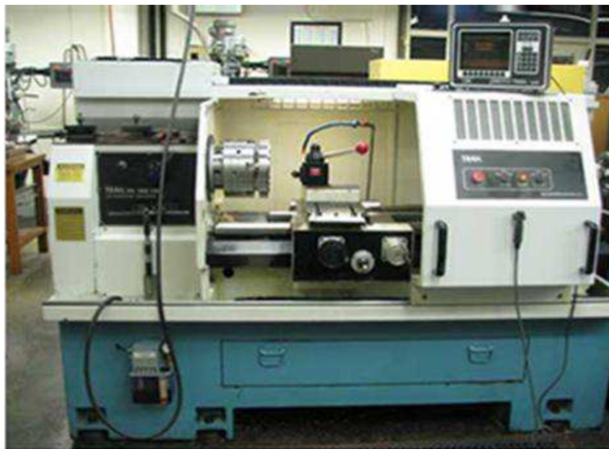
Figura 72: Torno CNC sem adaptações para o roleteamento
