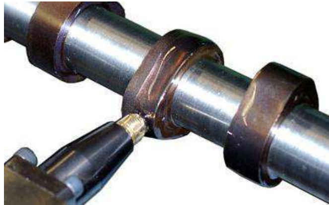
Figura 53: Eixo comando de válvulas sendo roleteado (www.ecoroll.de)
