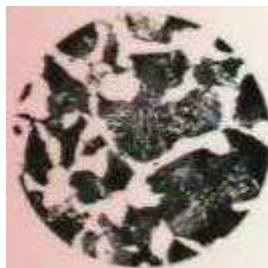
Figura 26: Micro-estrutura da cementita e perlita (estrutura interna da perlita) ( www.cimm.com.br )
