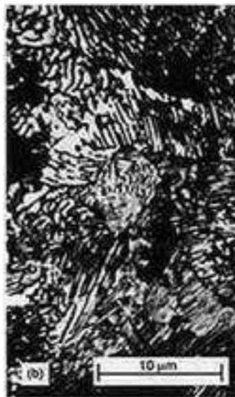
Figura 25: Micro-estrutura da perlita fina ( www.cimm.com.br )
