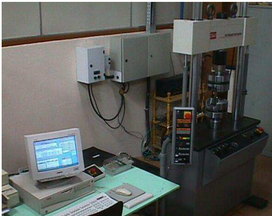
Figura 75: Máquina de ensaio de fadiga
