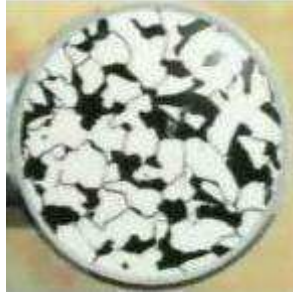
Figura 24: Micro-estrutura da ferrita e perlita (ferrita é clara e a perlita é escura) ( www.cimm.com.br )
