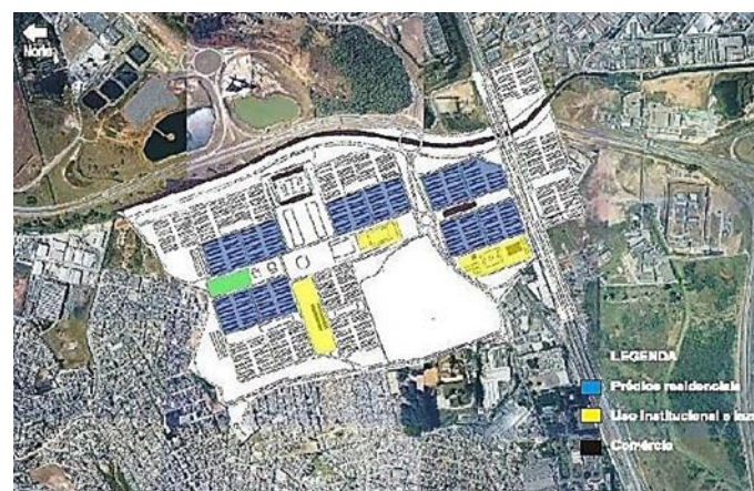
Figura 10. Implantação do Conjunto Habitacional Zezinho Magalhães Prado/Parque CECAP com destaque no que foi construído – Fonte: ISAAC (2007).
