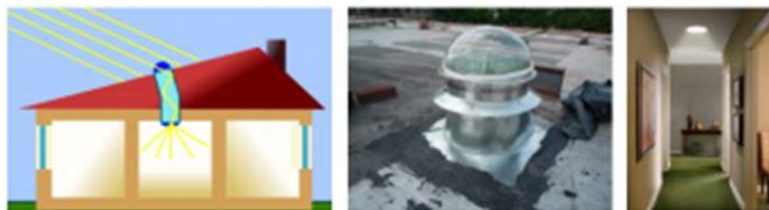
Figura 49. Figuras - Princípio de funcionamento dos ductos solares – Fonte: google.com.br
