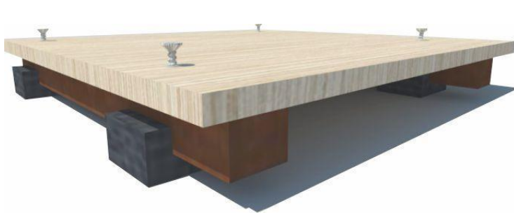
Imagem 95: fixação do caibro com o piso.
