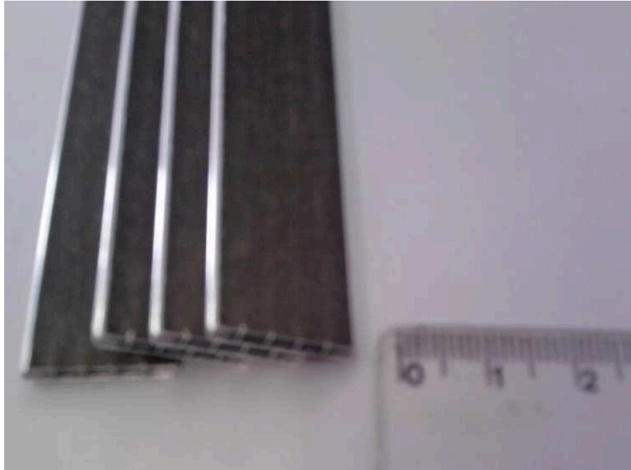
Figura 14 – Imagem do tubo chato utilizado na fabricação de evaporadores
