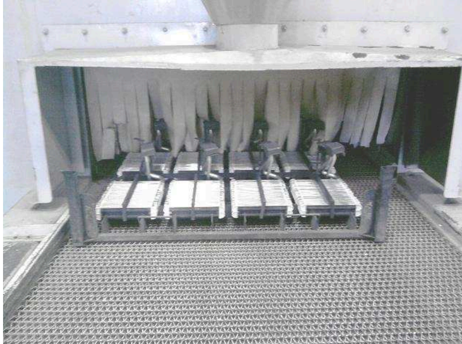
Figura 19 - Grelhas com evaporadores entrando no termodesengraxe
