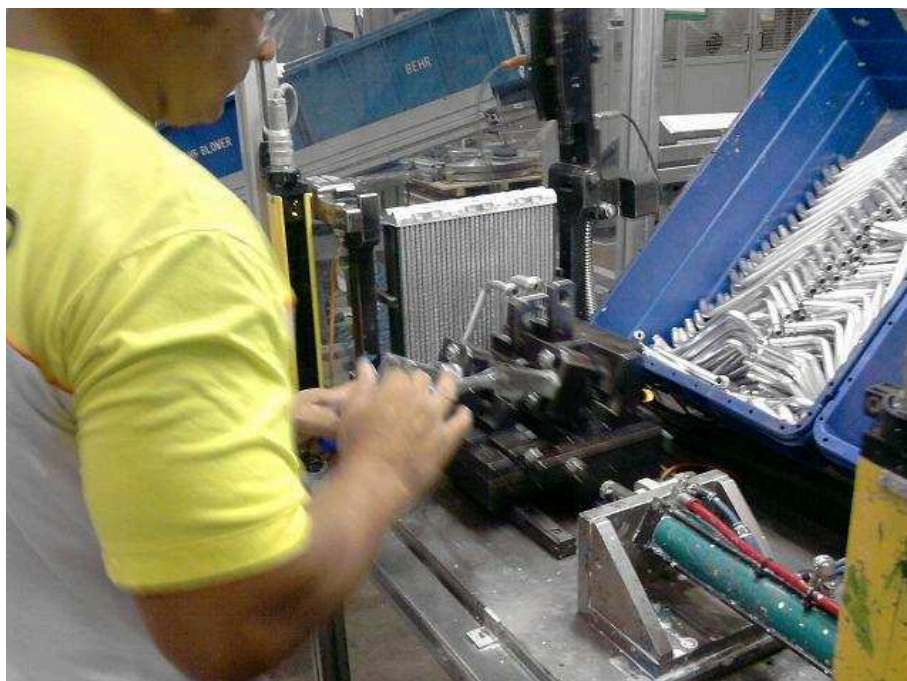
Figura 17 – Máquina de recravagem de tubo de sucção e tubo de líquido
