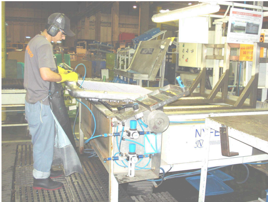
Figura 27 – Teste de estanqueidade por imersão em tanque com água (OLIVEIRA, et al., 2010)
