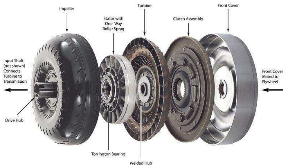
Figura 4 - Vista explodida de um conversor de torque
