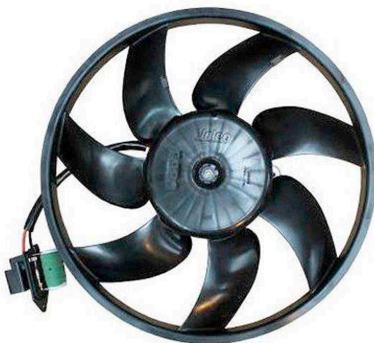
Figura 26 - Eletro ventilador de refrigeração
