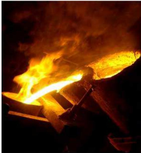
Figura 1 - Vazamento de metal líquido em molde (MACHADO, 2009)
