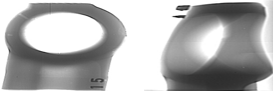
Figura 2 – Radiografia do pistão de aço - (posições 0° e 90°)
