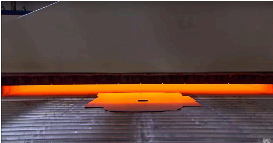
Figura 26 - Aquecimento do blanque na temperatura de austenitização
