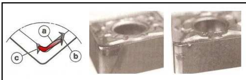
Figura 3 - Ilustrações do desgaste de flanco (a) e dos desgastes de entalhe (b) e (c). Fotos de insertos com os desgastes mencionados.
