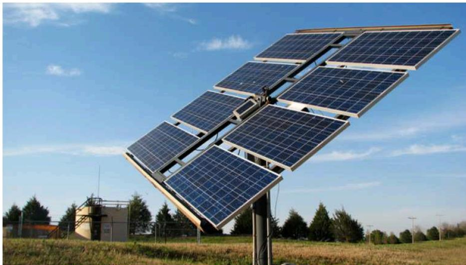
Figura 7: Painel fotovoltaico
