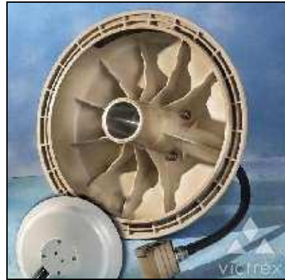
Figura 23 – Calotas do sistema de monitoramento dos freios do avião Boeing 777 (VICTREX, 2009).
