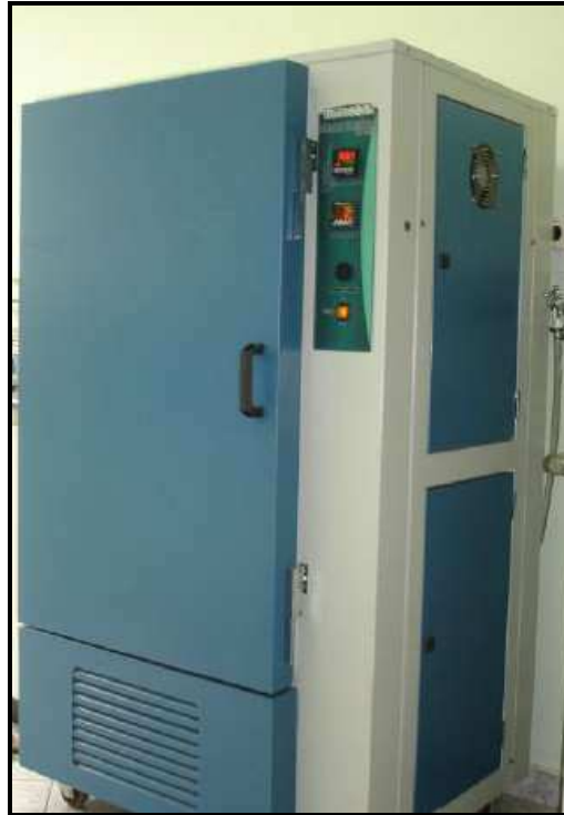
Figura 43 – Câmara de condicionamento higrotérmico da marca Marconi modelo MA 835/UR.
