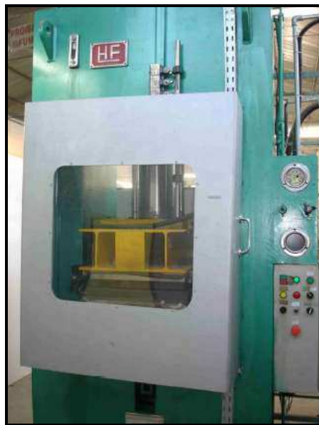
Figura 38 – Prensa hidráulica utilizada para o processamento via moldagem por compressão a quente dos compósitos de PEEK / fibra de carbono (cortesia da empresa ALLTEC Materiais Compósitos).
