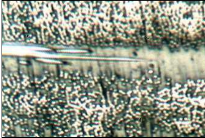
Figura 52 – Imagem obtida por microscopia óptica do compósito termoplástico de PEEK/fibra de carbono.
