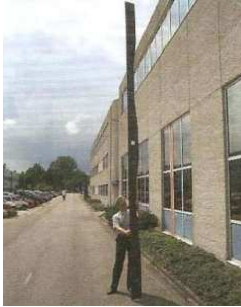
Figura 5 – Longarina do piso em compósito termoplástico de PEKK/fibra de carbono (JEC, 2010).
