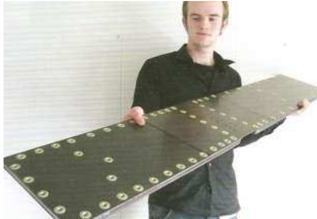
Figura 3 – Painel do piso da caverna de pressão das aeronaves Gulfstream G550 e G650 (JEC, 2010).
