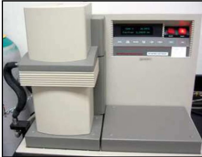
Figura 45 – Equipamento TA Instruments - 2980 TMA V1.7B. Acoplado a um termo-analisador preparada para o ensaio de DMTA.
