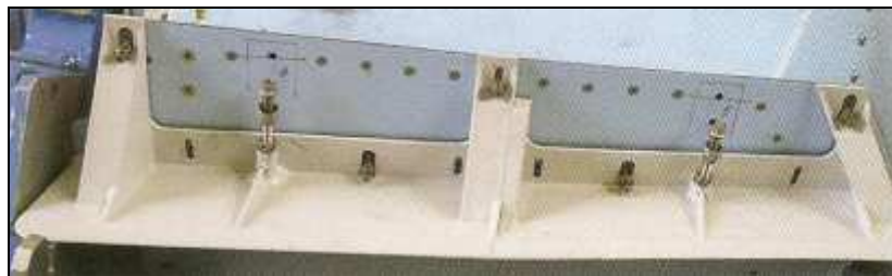
Figura 22 – Carenagem do Pilone em compósito polimérico de PEEK (VICTREX, 2009).
