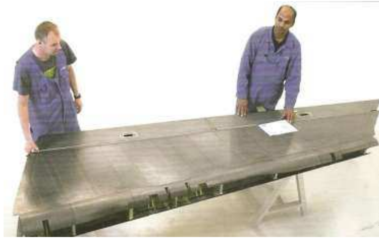
Figura 4 – Leme obtido com compósito termoplástico do novo jato executivo Gulfstream G650 soldado por indução (JEC, 2010).
