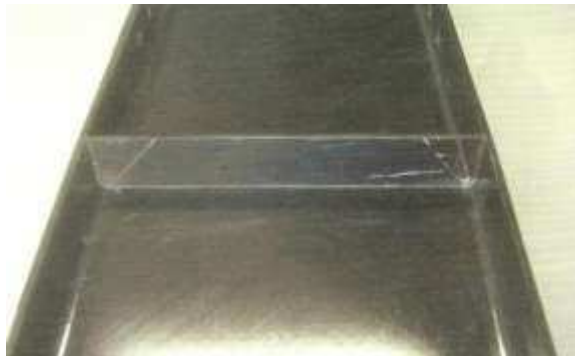
Figura 6 – Junta de topo ( butt joint ) entre a nervura reforçadora com a longarina (JEC, 2010).
