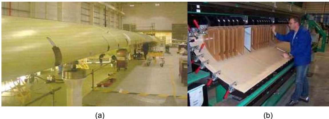
Figura 2 – (a) Bordo de ataque da asa do Airbus A380; (b) Soldagem por resistência do bordo de ataque (JEC, 2010).
