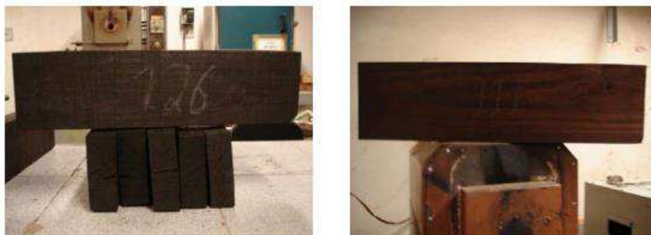
Figura 14-Madeira tratada termicamente a 240 °C, a esquerda E. citriodora e à direita Pinus taeda
