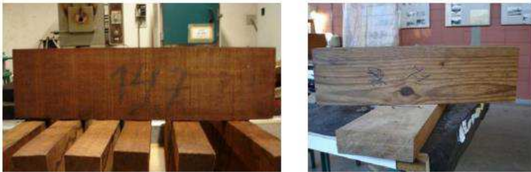
Figura 10- Madeira tratada termicamente a 180 °C
