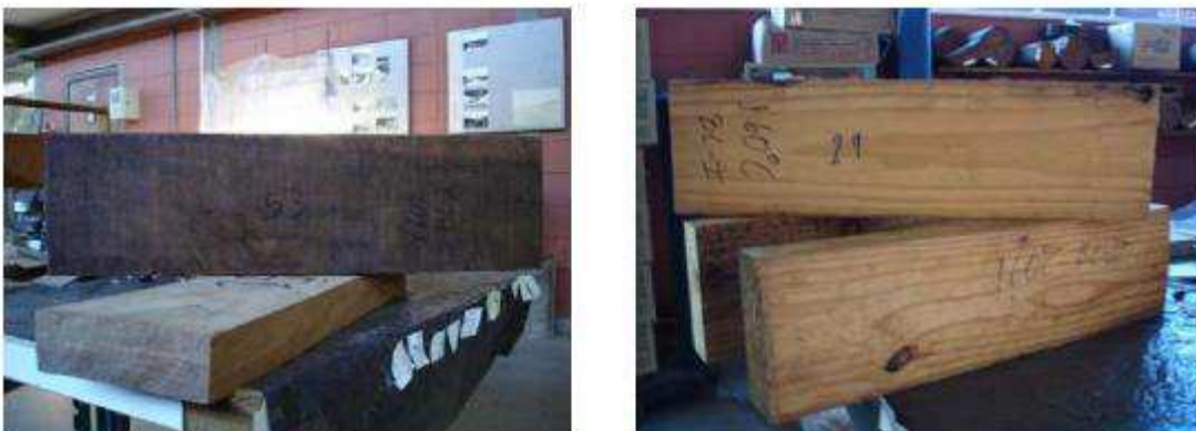
Figura 9-Madeira tratada termicamente a 160 °C
