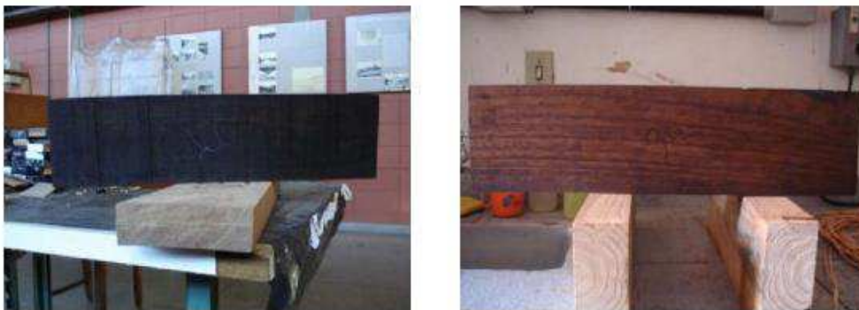
Figura 13-Madeira tratada termicamente a 220 °C, a esquerda E. citriodora a direita Pinus taeda
