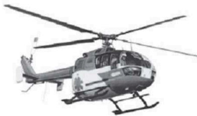
Messerschmitt-Bölkow-Blohm BO-105: configuração com rotor principal e rotor de cauda anti-torque
