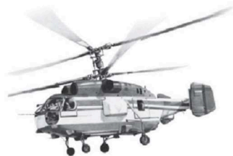
Kamov Ka-32: configuração com rotores coaxiais
