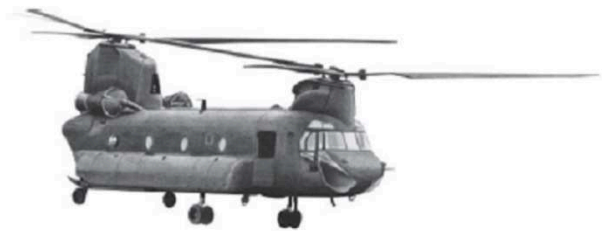
Boeing CH-47: configuração com rotores em "tandem"
