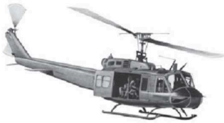
Bell UH-1: configuração com rotor principal e rotor de cauda anti-torque
