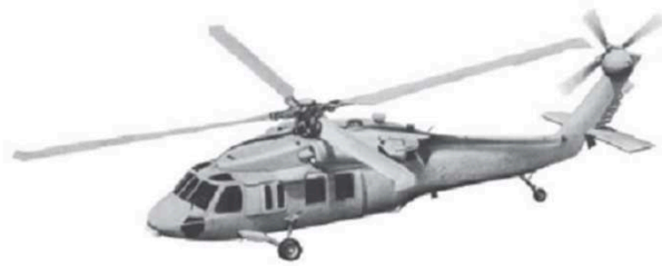
Sikorsky SH-60: configuração com rotor principal e rotor de cauda anti-torque
