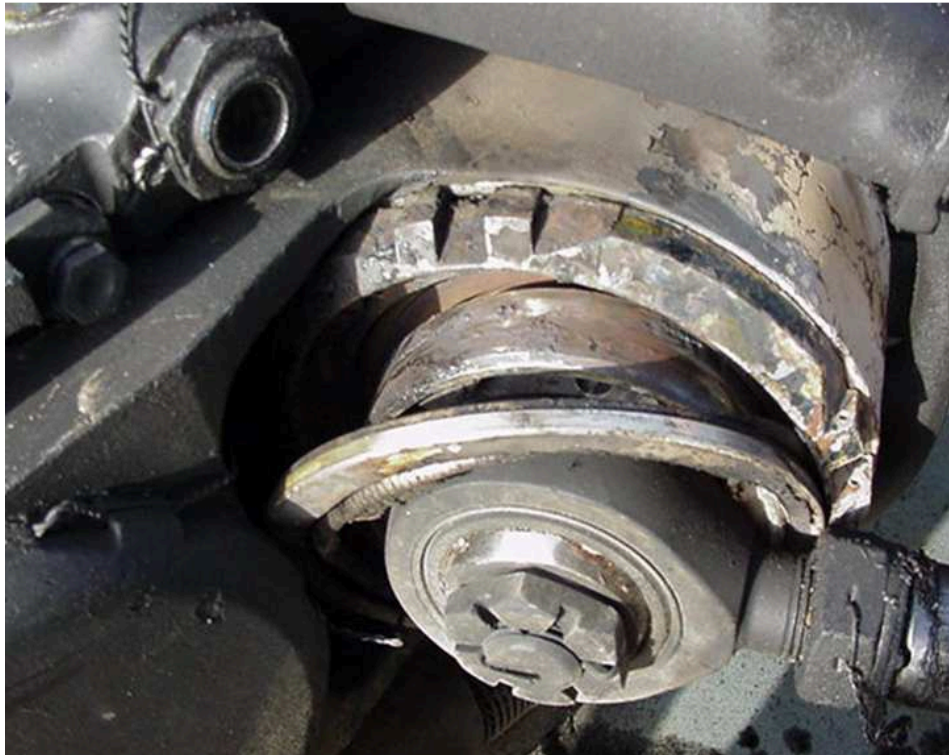
Figura 29 - Detalhe da falha no mancal da cabeça do rotor principal da aeronave Sikorsky S-61.
