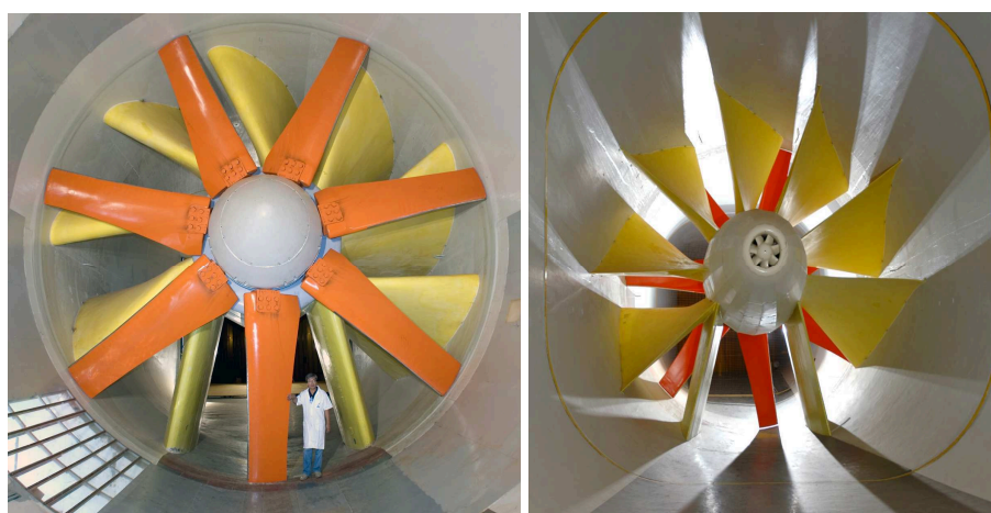
Figura 68 - Sistema de propulsão do Túnel nº 2 da Divisão de Aerodinâmica (ALA 2009)
