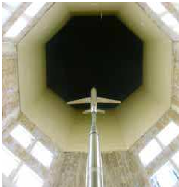
Figura 54 - Modelo padrão M4 da ONERA M-série montado no T-35 (OCOKOLJIC, 2004)
