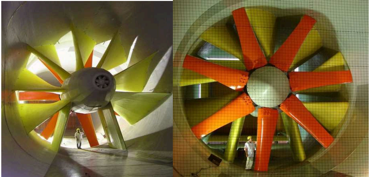
Figura 07 - Vista frontal e traseira da hélice e estator (ALA, 2009)
