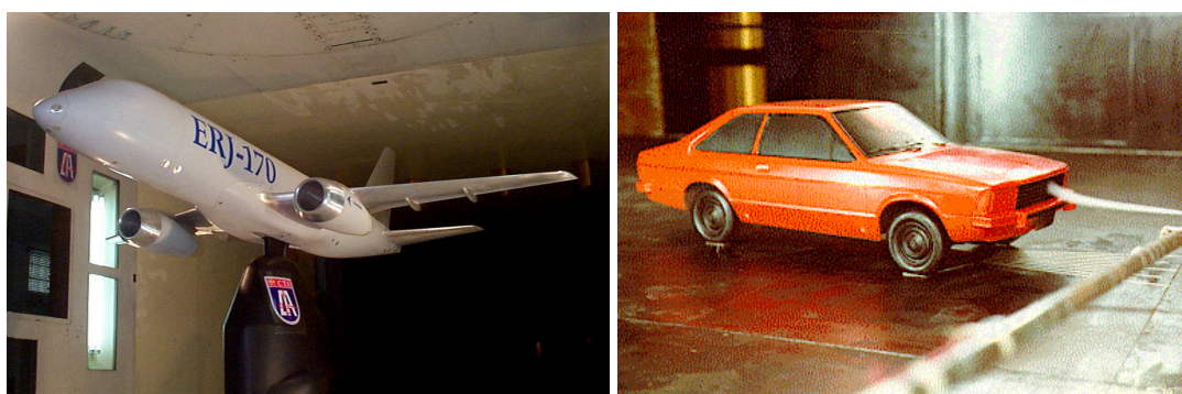
Figura 69 - Ensaio típicos do Túnel nº 2 da Divisão de Aerodinâmica (ALA 2009)
