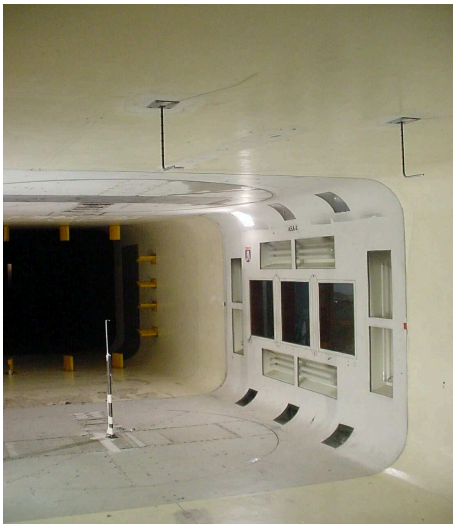
Figura 37 - Tubo de Pitot padrão no seção de ensaio (ALA, 2005)
