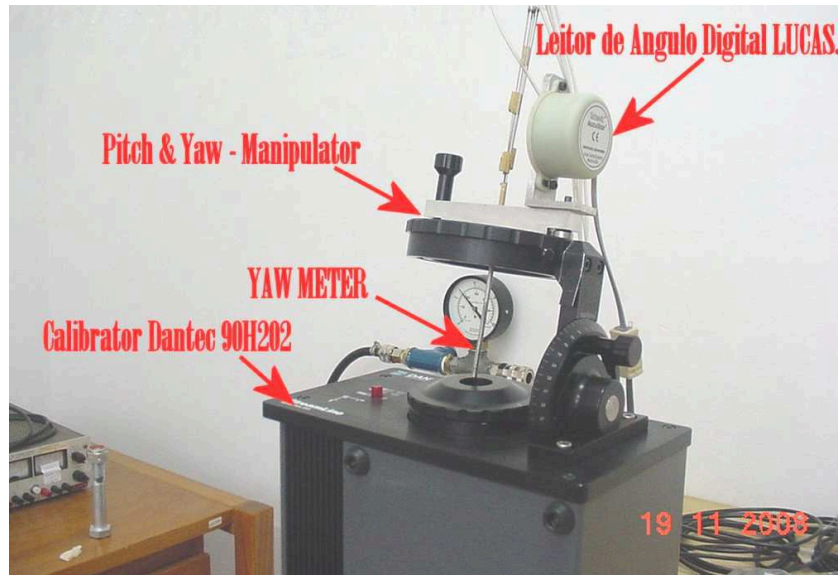
Figura 11 - Calibração do yaw meter : (SADAHAKI, CHISAKI, 2008)
