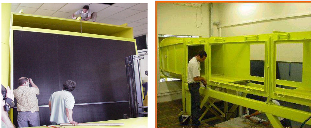
Figura 71 - Bocal de entrada e seção de ensaio do Túnel de Vento do Instituto Tecnológico de Aeronáutica (Projeto FAPESP 00 / 13769-0)
