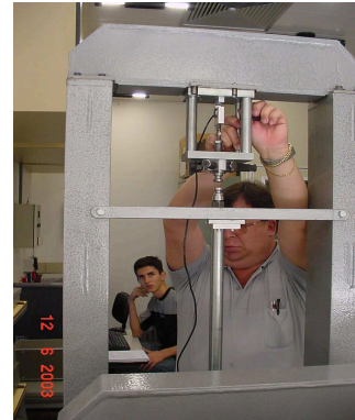
Figura 35 - Estojo na Máquina de calibração (ALA, 2005)
