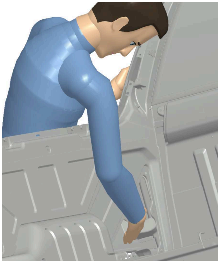
Figura 25 – Imagem da solução final, após o último repasse de engenharia, durante o Ring Digital no caso da montagem do extrator de ar.
