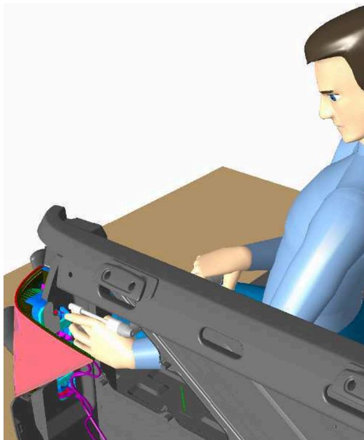
Figura 23 – Imagem da solução final, após o último repasse de engenharia, durante o Ring Digital no caso da montagem da lanterna traseira.
