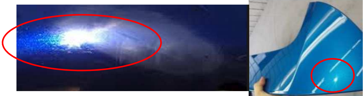
Figura 30 - Foto de evidências de rejeição por marcas de polimento
