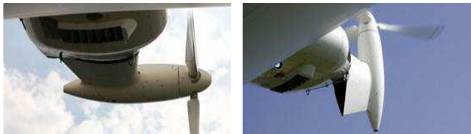
Figura 14 – Sistema giratório das hélices utilizado no Zeppelin NT
