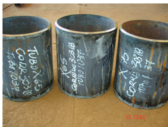
Figura 18 - Tubos API 5L X65 com biseis usinados (fonte: autor)
