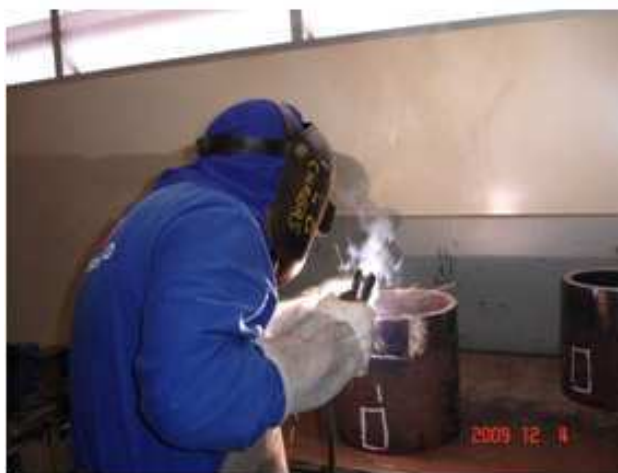
Figura 22 – Soldador realizando amanteigamento na extremidade do tubo (fonte: autor)
