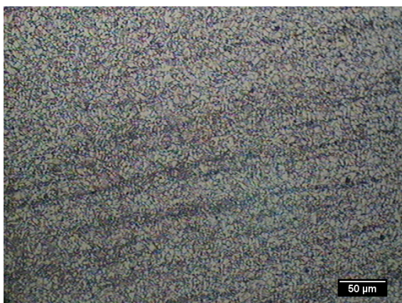
Figura 86 - Ponto 19 – Transição entre o metal de base API 5L X65 e a zona afetada pelo calor. Transição suave praticamente imperceptível. Microestrutura constituída por finos grãos ferríticos. Aumento 500X.
