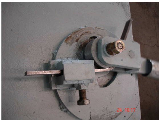
Figura 62 - Dispositivo para o dobramento semi-guiado (fonte: autor)
