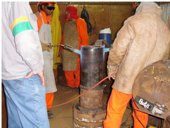
Figura 26 – Pré-aquecimento da junta (MENEZES et al., 2010)
