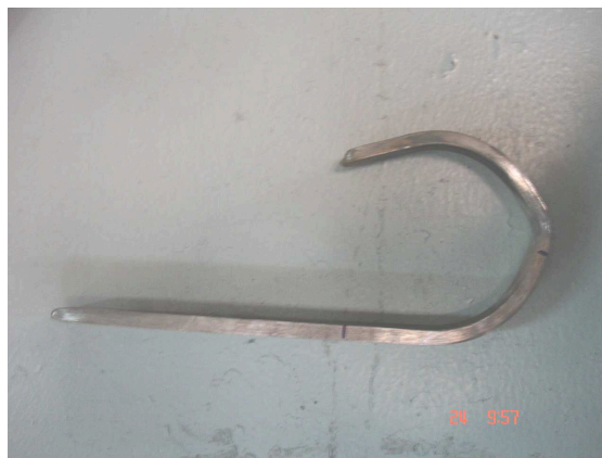
Figura 63 – Corpo de prova após ensaio de dobramento (fonte: autor)
