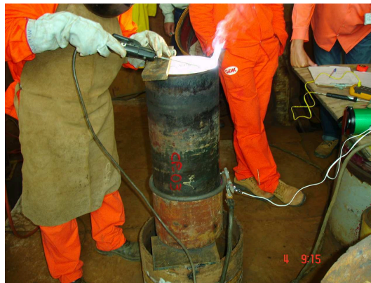
Figura 27 – Deposição do amanteigamento (MENEZES et al., 2010)
