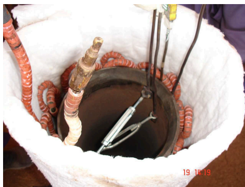
Figura 29 - Posicionamento dos termopares no tubo (fonte: autor)
