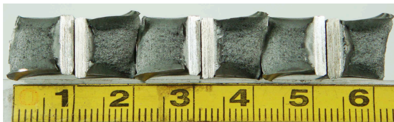
Figura 39 – Corpos de prova apresentando aspecto de fratura totalmente dúctil (fonte: autor)
