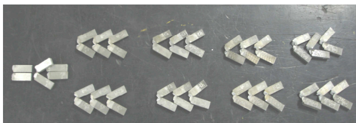
Figura 64 - Corpos de prova Charpy após ensaio (fonte: autor)
