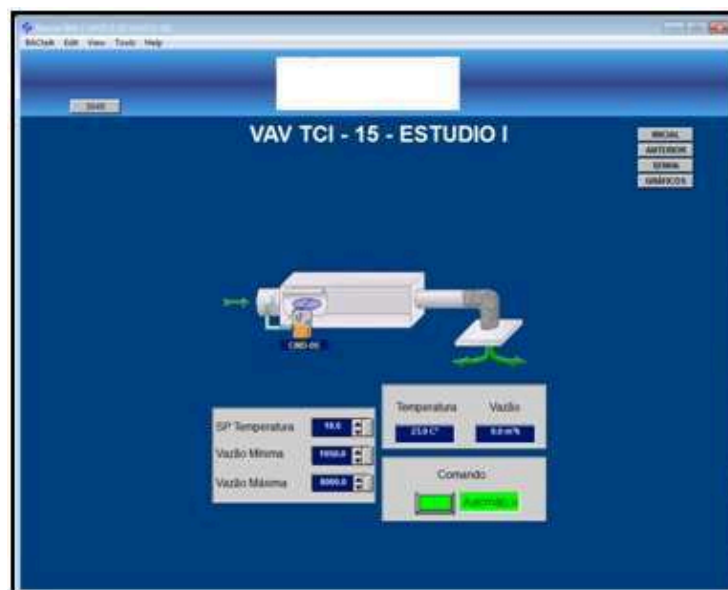
Figura 13 – Tela Supervisório VAV-15 Estúdio I Fonte: RECORD (2010)
