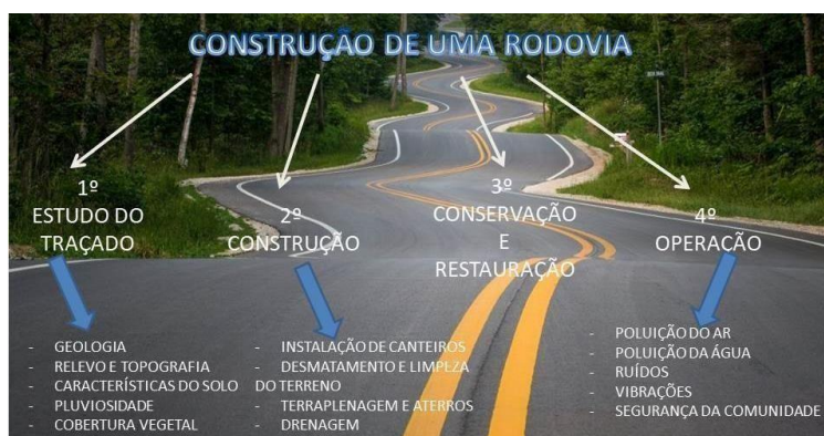
Figura 11 – Etapas para a construção de uma Rodovia
