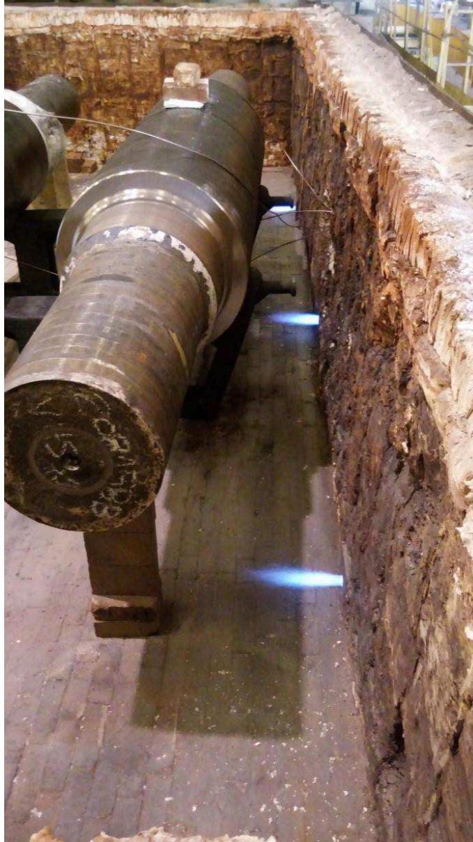
Figura 2- Cilindro VHCR em tratamento no forno a gás
