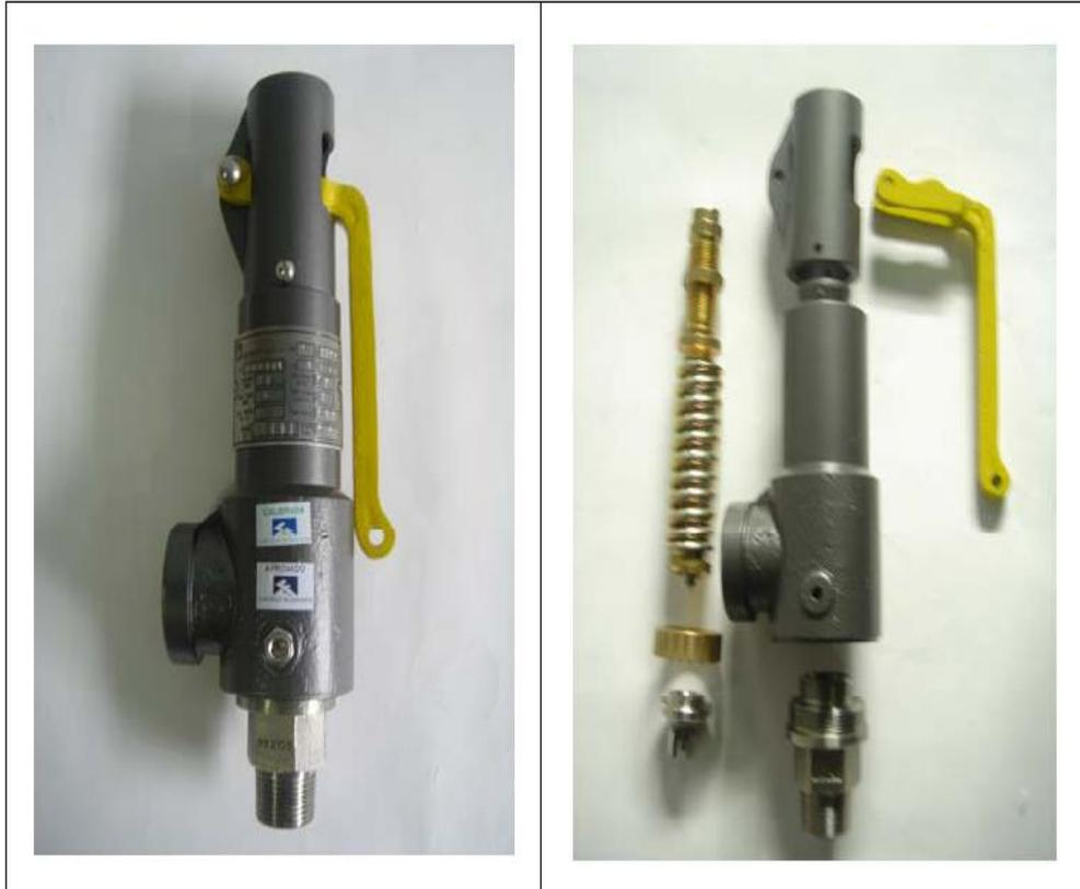
Figura 1 Válvula de segurança montada
