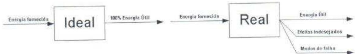
Figura 7 - Processo de transformação nas formas ideal e real.
