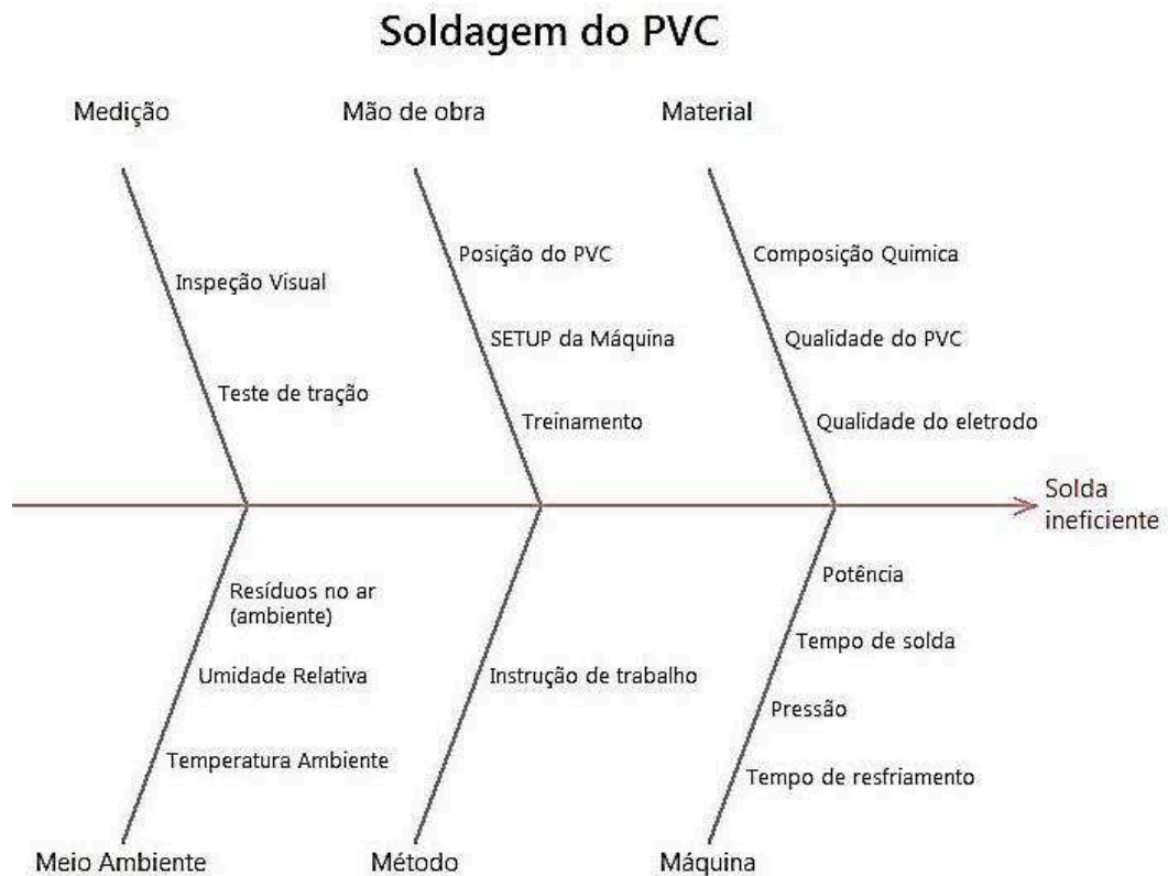
Figura 8 - Diagrama de Causa e Efeito (variáveis do processo de soldagem do PVC)
