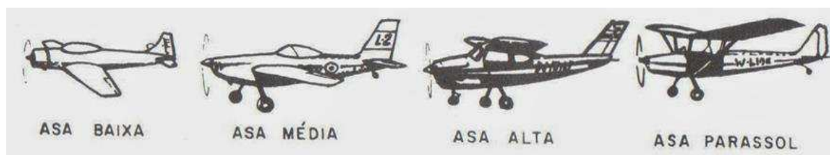
Figura 10 -Tipos de fixação das asas
