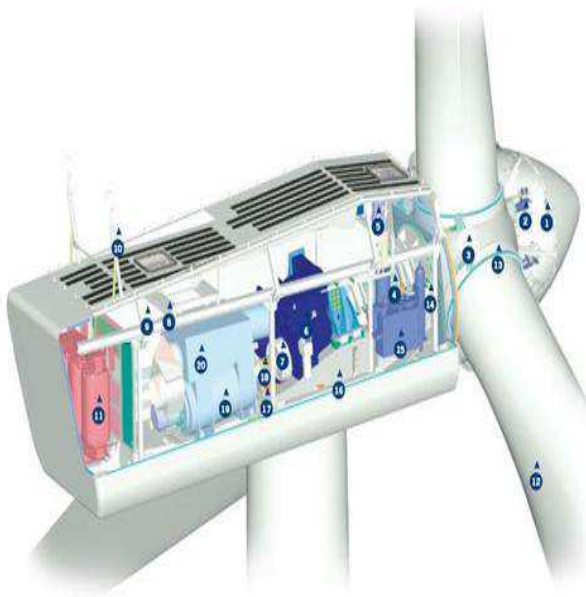
Figura 16 - Componentes de uma Nacele convencional (de eixo horizontal):
