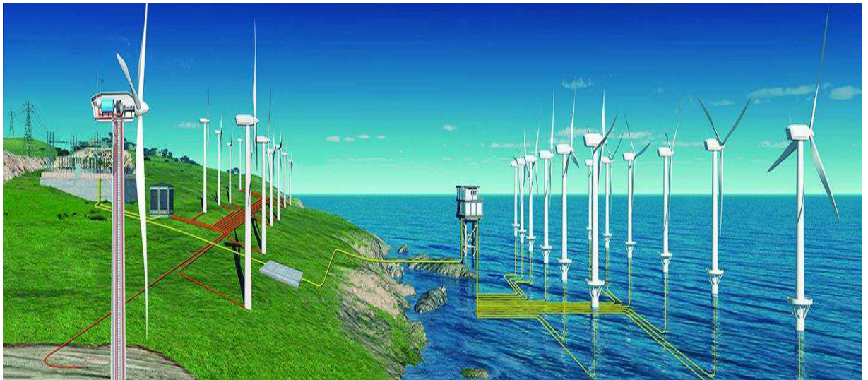
Figura 37 – Representação do sistema geração e seu cabeamento até a subestação.
