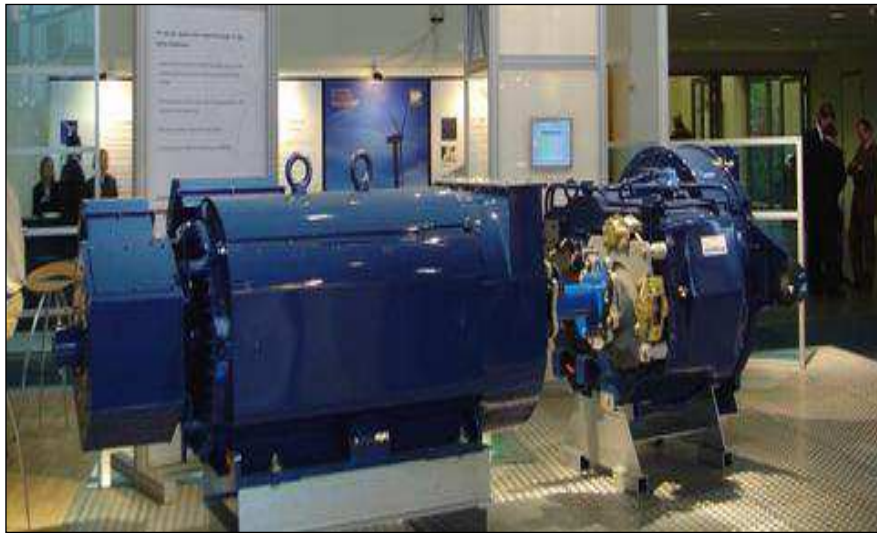
Figura 19 - Gerador conectado a caixa de engrenagens (vista à direita)
