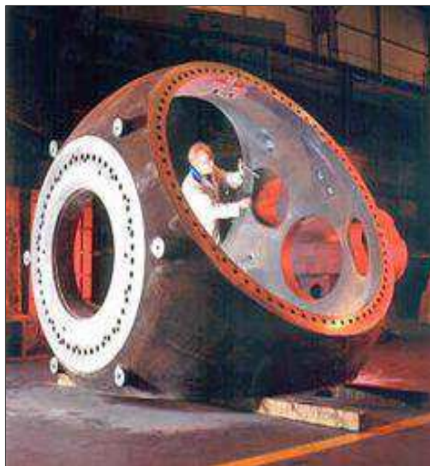
Figura 17 – Cubo do aerogerador de eixo horizontal sendo fabricado
