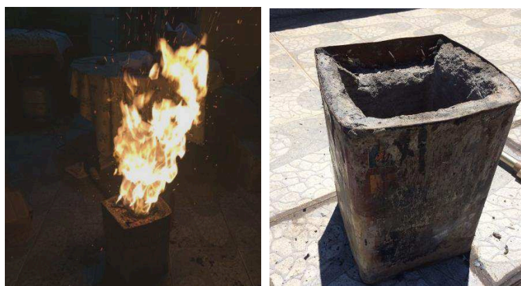
Figura 10 - Forno artesanal alimentado por carvão vegetal e um sistema de sopro de ar
