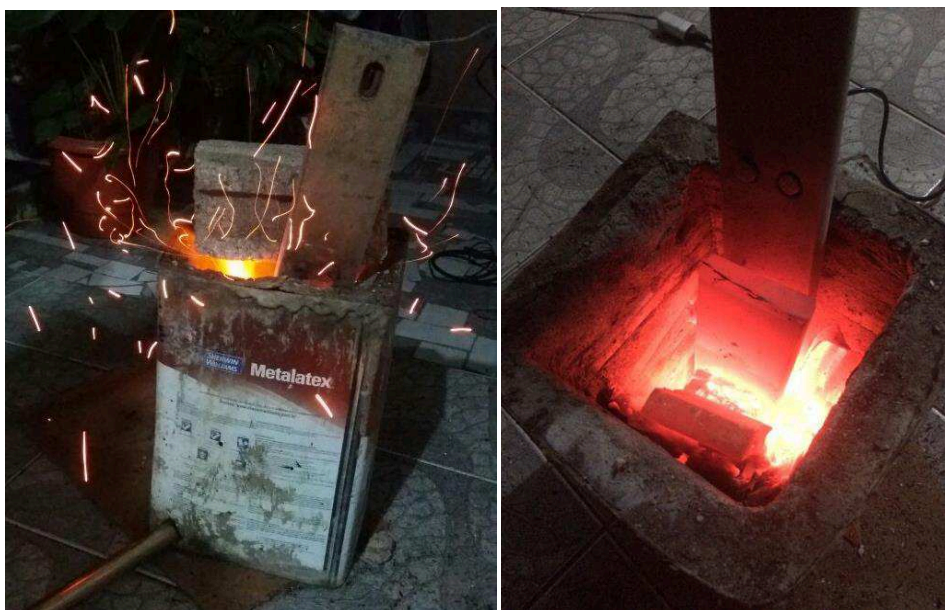
Figura 23 - Aquecimento e resfriamento lento para o processo de recozimento
