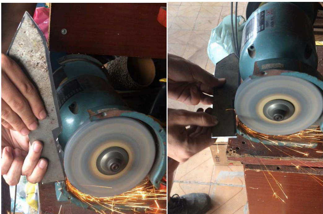
Figura 25 - Usinagem utilizando moto esmeril
