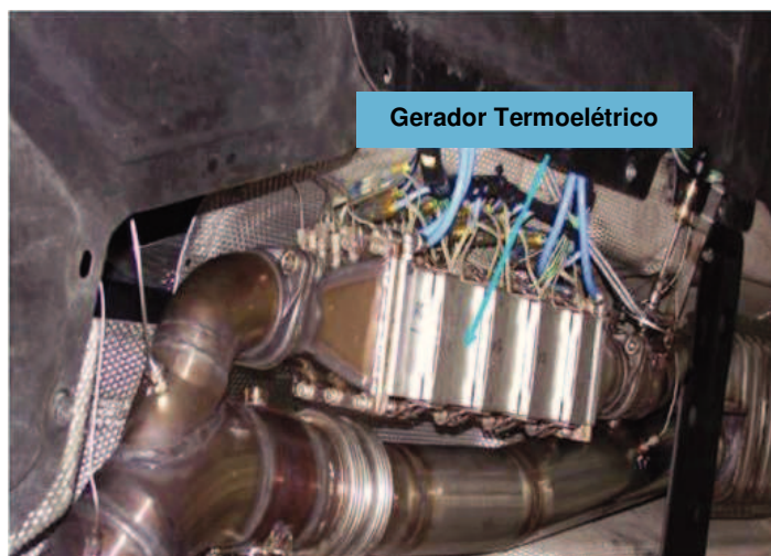
Figura 3 – Local de instalação do gerador no escapamento. (Fonte: FAIRBANKS, 2008)
