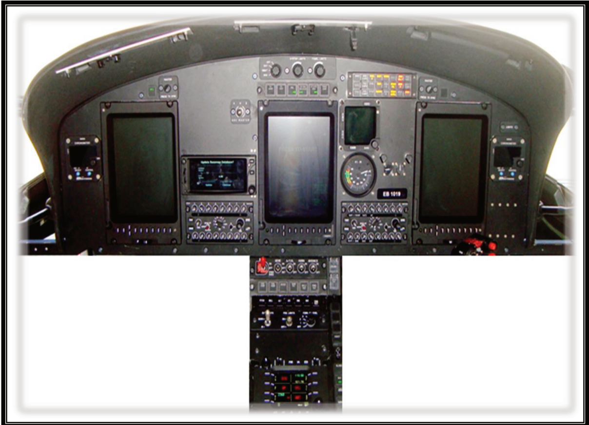
Figura 21 – Painel FENNEC após a modernização.
