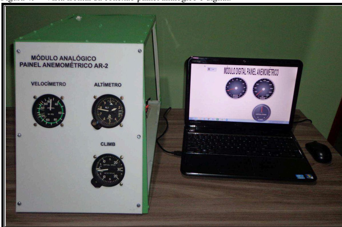
Figura 49 – Vista frontal da conexão painel analógico e digital.
