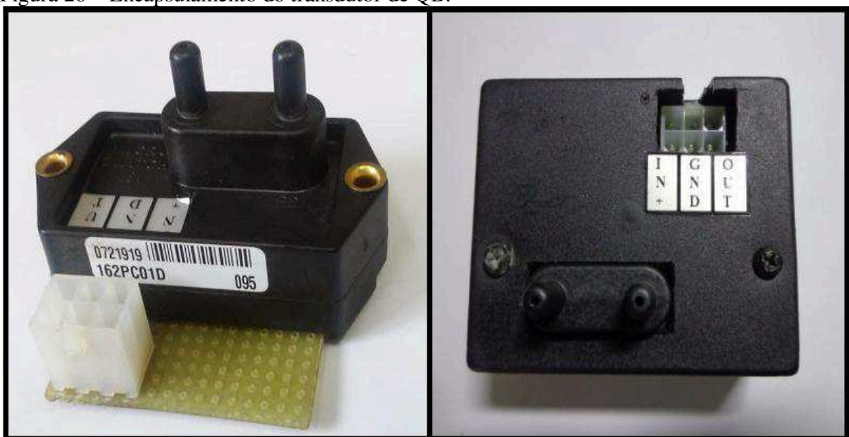
Figura 26 – Encapsulamento do transdutor de QB.
