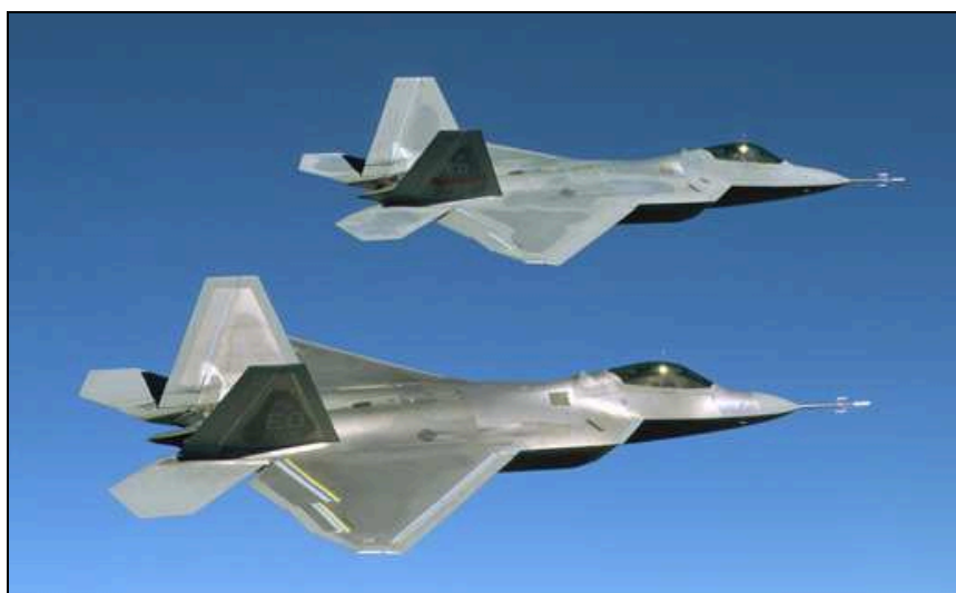
Figura 23 – Caça da Força Aérea norte-americana F-22 Raptor: fabricado com 1% em peso com compósitos termoplásticos (AIR FORCE TECHNOLOGY, 2010).
