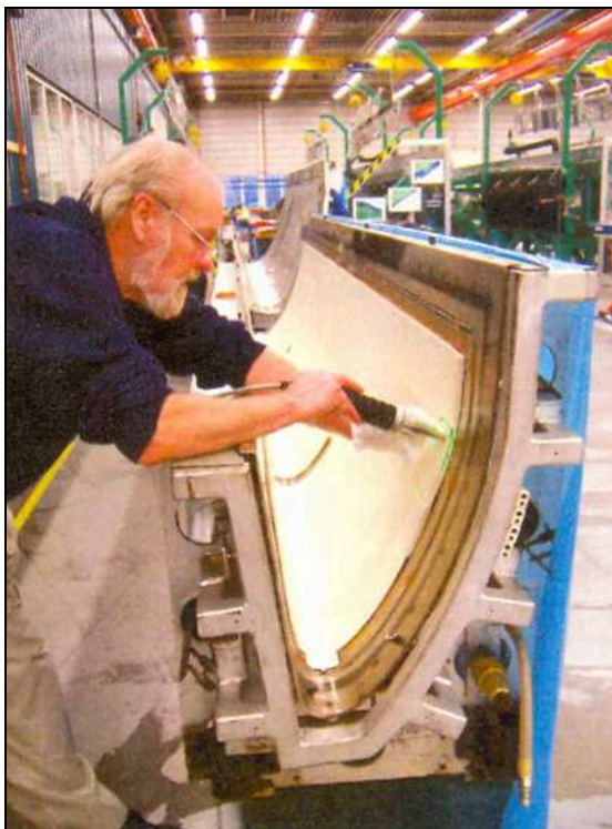
Figura 15 – Laminação manual de um revestimento com pré-impregnado termoplástico utilizando aquecedor ultra-sônico (BERSEE, 2006).
