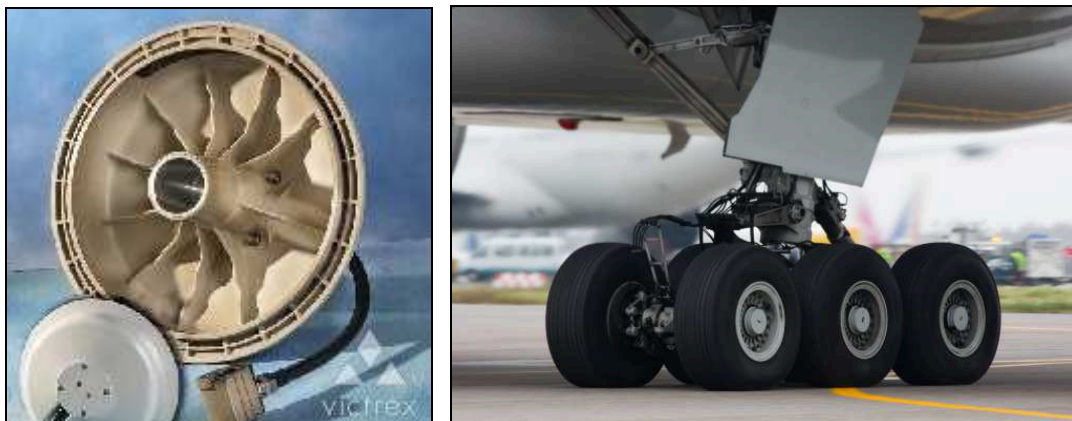
Figura 22 – a) Calotas que incorporam o sistema de monitoramento de freios e pneus do avião Boeing 777 e b) Trem de pouso principal do avião Boeing 777-300 (VICTREX PEEK, 2010).
