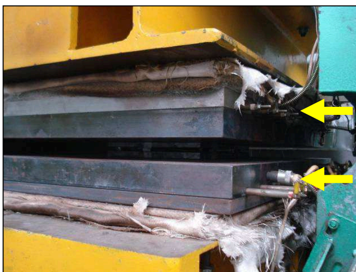
Figura 33 - Detalhe dos pratos de aço carbono com aquecimento resistivo controlado (setas amarelas).
