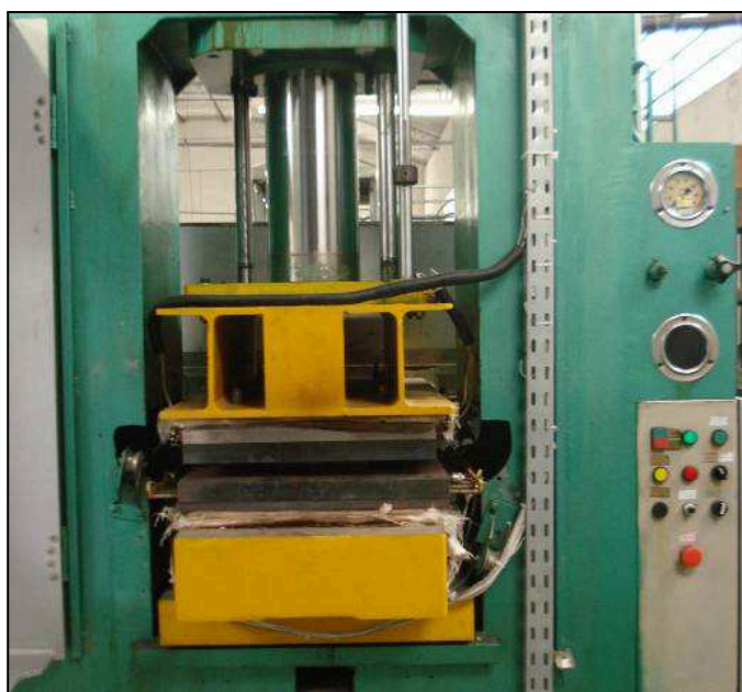
Figura 32 - Vista geral da prensa hidráulica adaptada com pratos equipados com aquecimento controlado.
