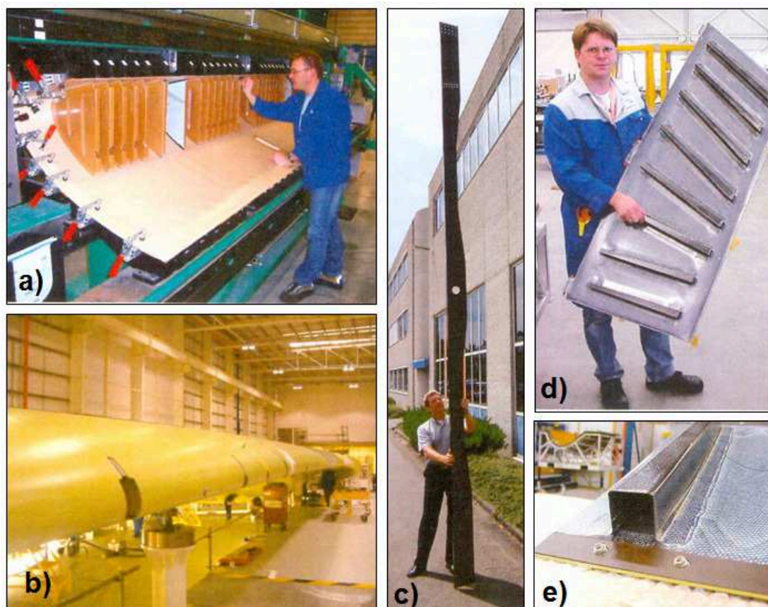
Figura 13 – Aplicações de compósitos termoplásticos nas aeronaves Airbus: a) bordo de ataque de asa da aeronave A-380, fabricado com PEI/carbono; b) bordo de ataque de asa da aeronave A-380 pronto para ser instalado; c) longarina transversal de piso da aeronave A-380, fabricado com PEKK/carbono; d) painel de acesso de asa da aeronave A-340, fabricado com PPS/carbono e e) detalhe do reforçador integrado ao painel (BERSEE, 2006).
