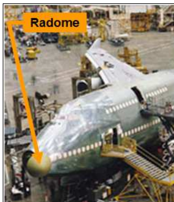
Figura 02 – Radome fabricado com matriz polimérica de PBI, utilizado nas aeronaves Boeing 747 (PBI PERFORMANCE PRODUCTS, 2008).
