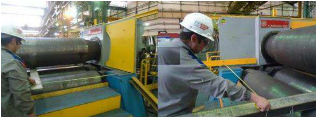
Figura 14 - Posicionamento da chapa metálica na calandra
