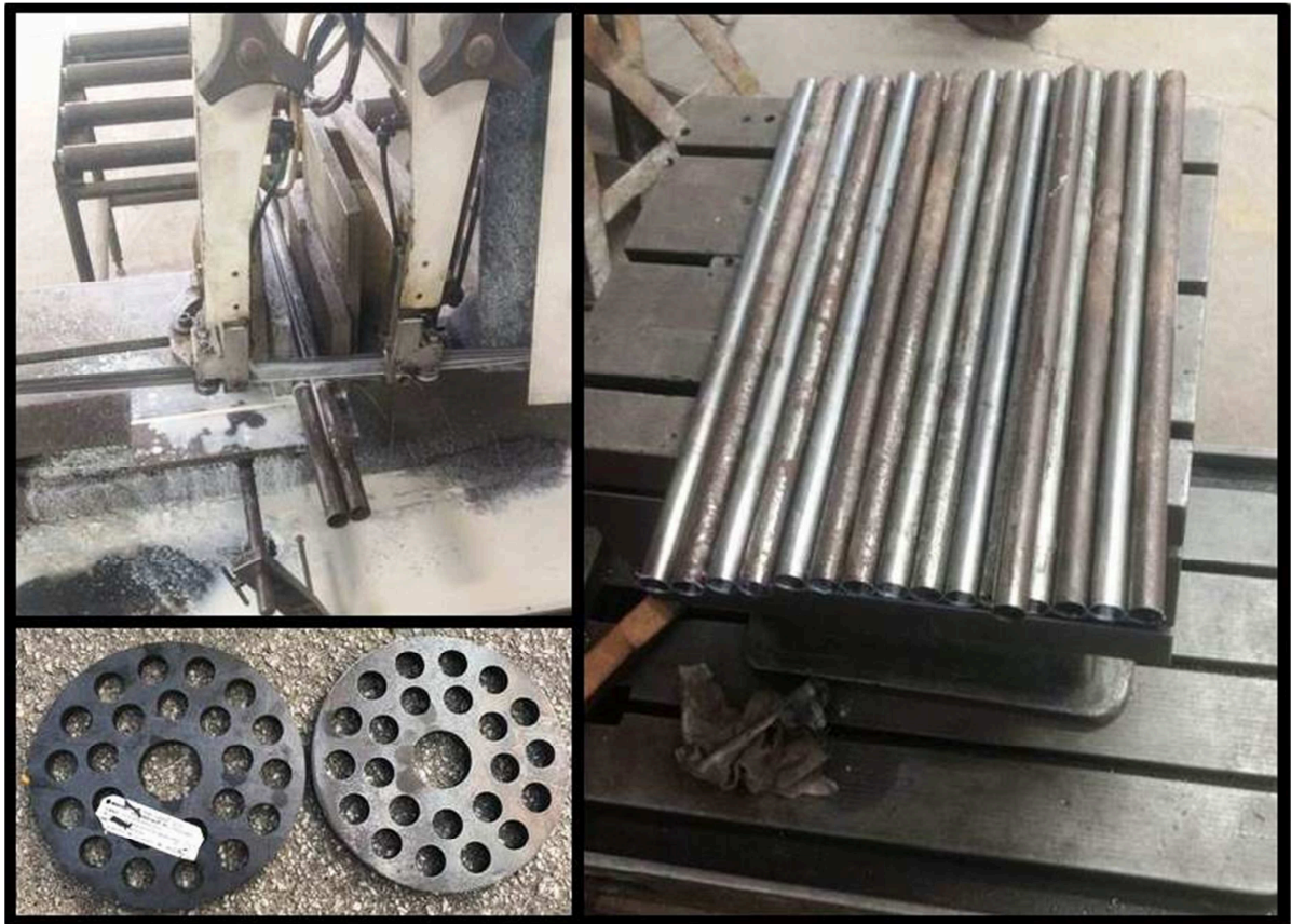
Figura 27 – Tubos trocadores de calor serrados na medida correta
