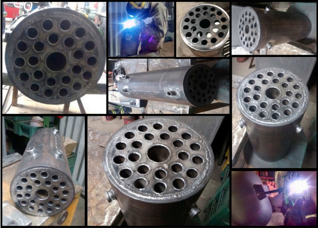
Figura 29 – Caldeira bruta, com todas as soldas finalizadas
