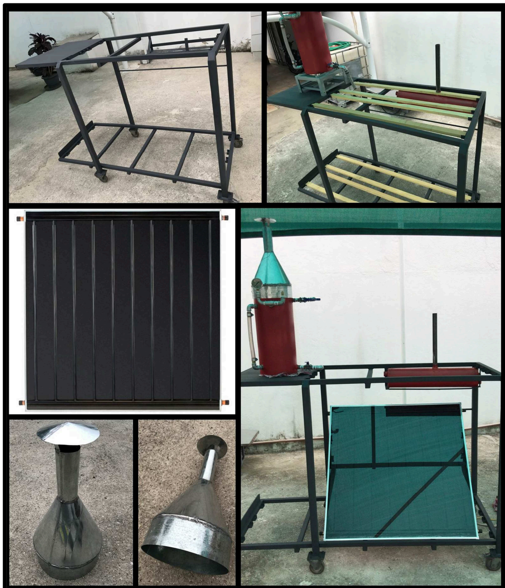
Figura 31 – Chaminé; Carrinho; Fogão; Placa solar; Boiler e Caldeira
