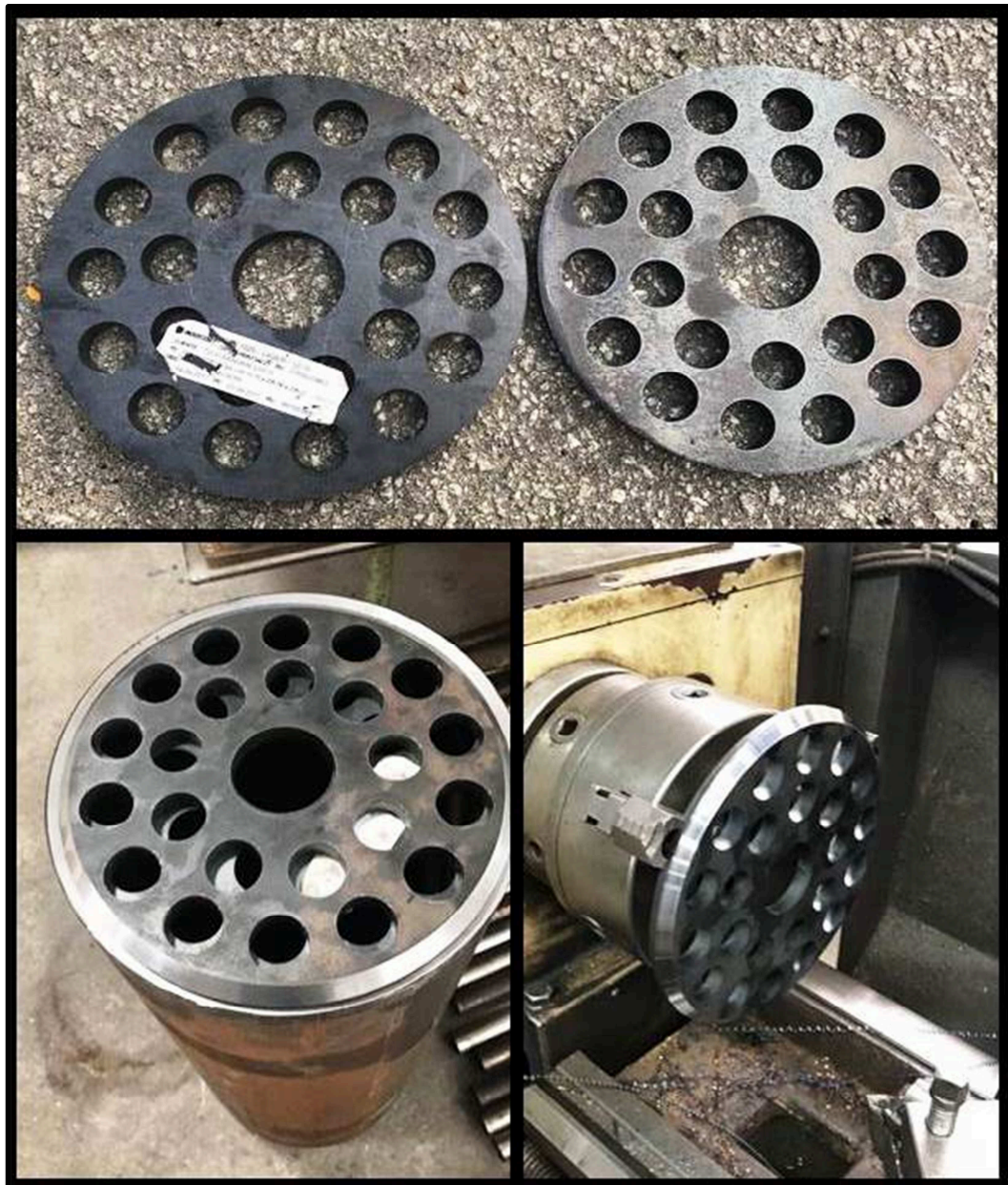
Figura 26 – Espelho cortado a plasma e usinado com chanfro
