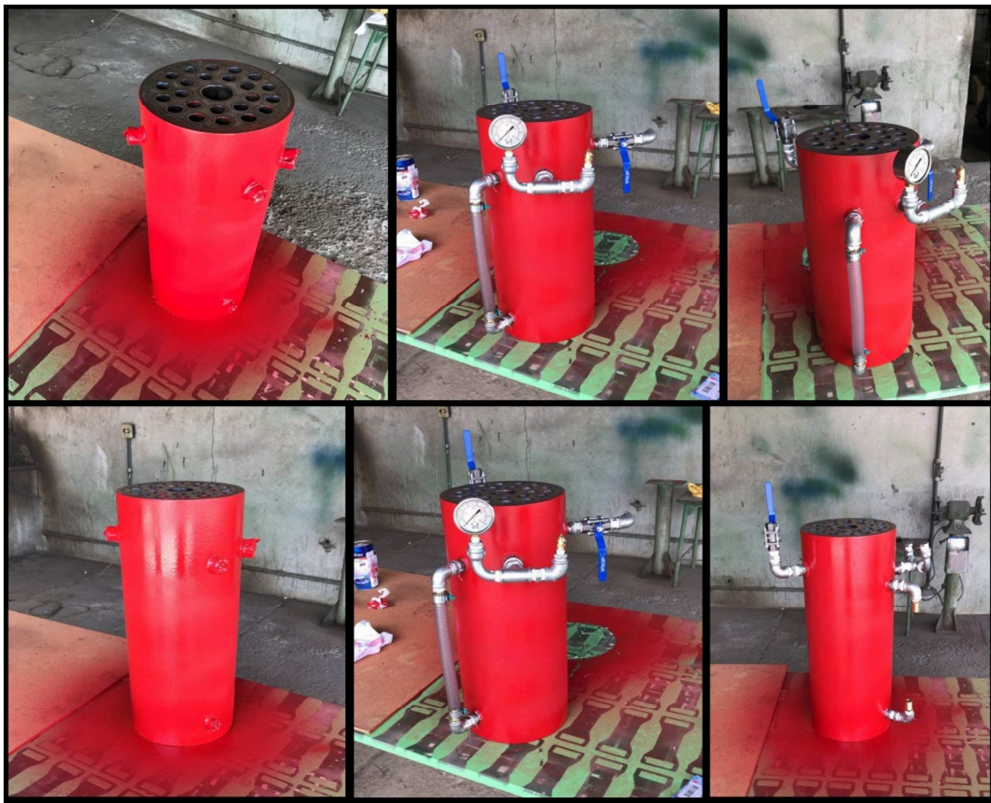
Figura 30 – Caldeira completa, com as válvulas, conexões e pintura
