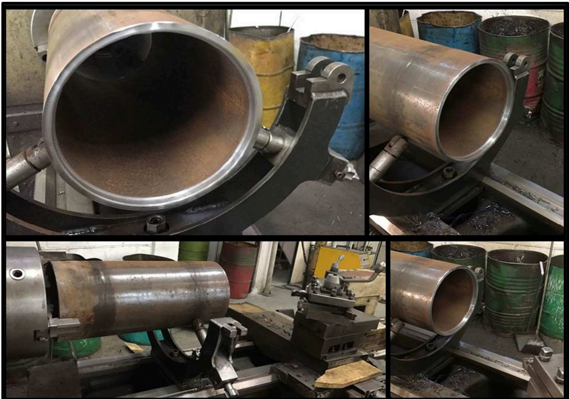
Figura 25 – Usinagem do tubo
