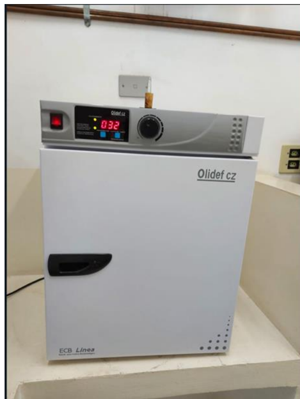
Figura 3 Estufa bacteriológica utilizada no estudo
