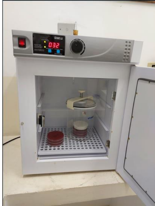
Figura 3.1. Estufa bacteriológica utilizada no estudo (aberta)
