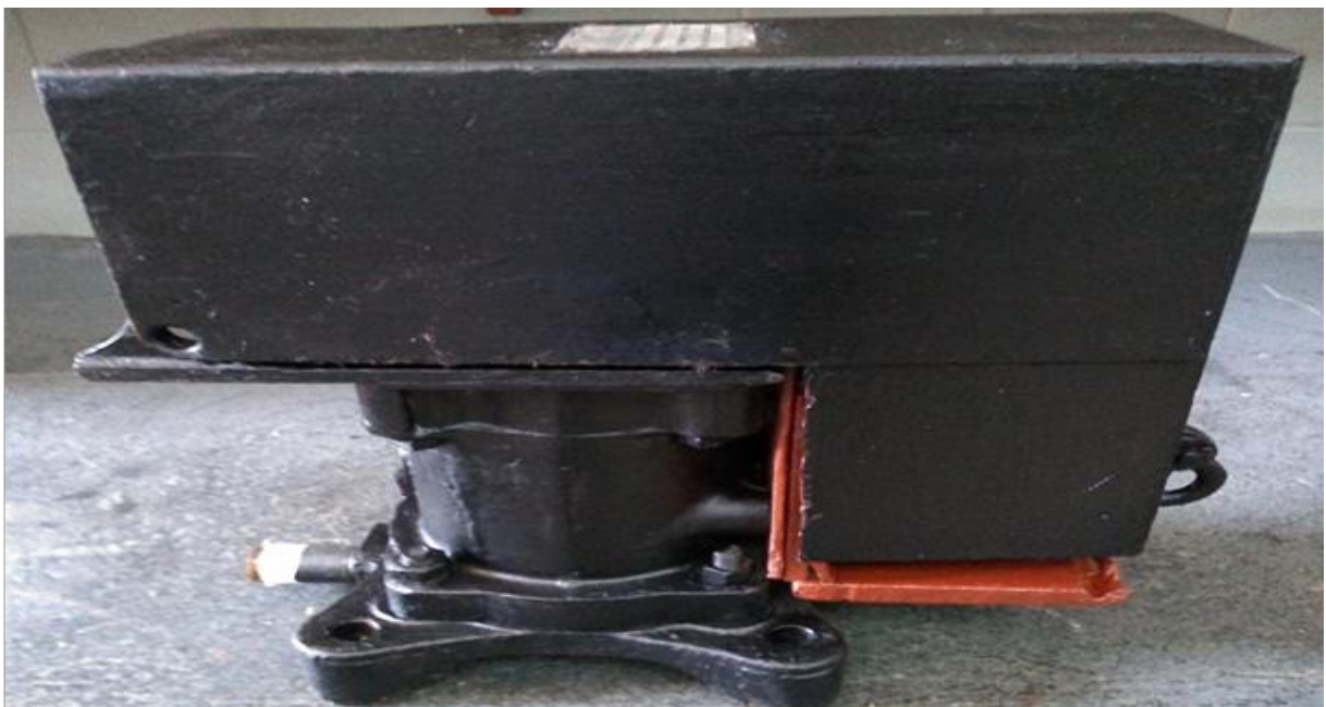
Figura 21: Aparência externa do pressostato utilizado na automotriz
