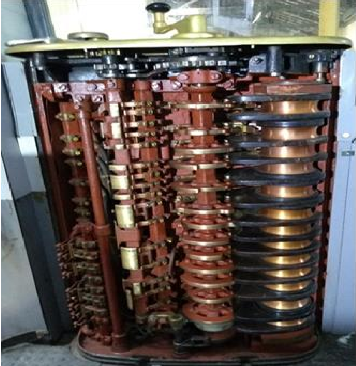
Figura 22: Design interno do controller utilizado na automotriz
