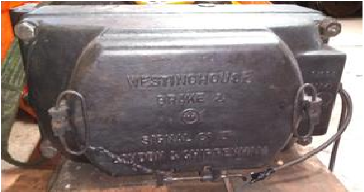
Figura 19: Aparência externa do compressor utilizado na automotriz
