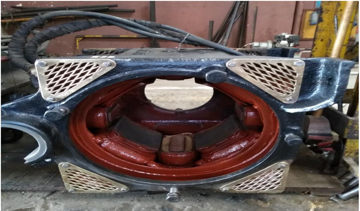
Figura 5: Carcaça do motor DK-30G
