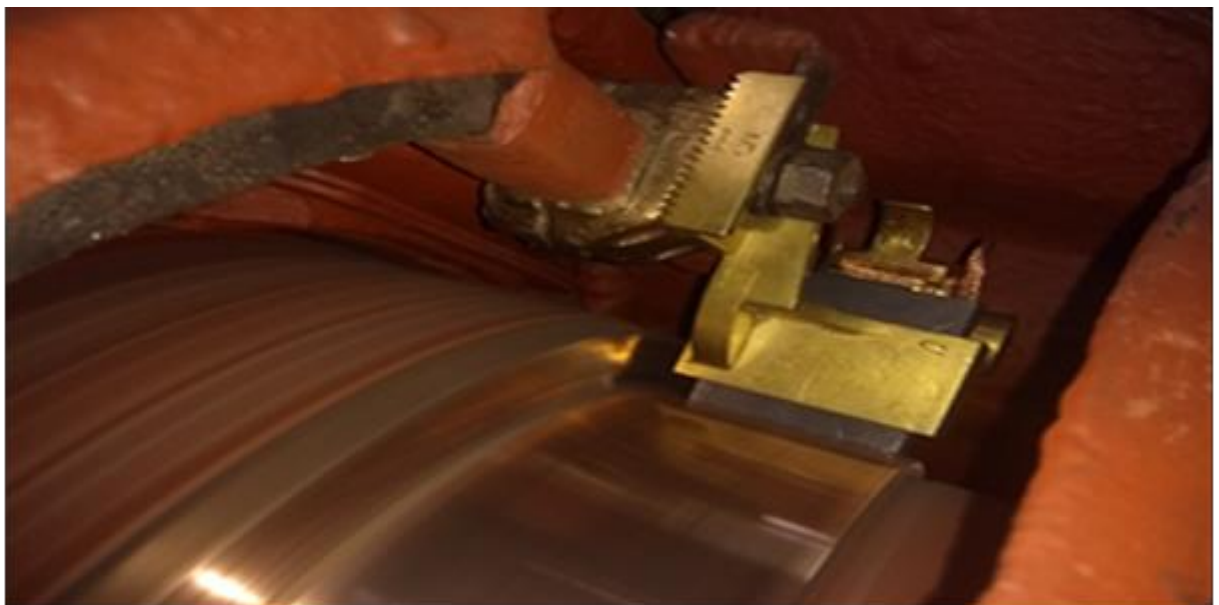
Figura 11: Modelo de porta-escovas e escova aplicado no motor DK-30G
