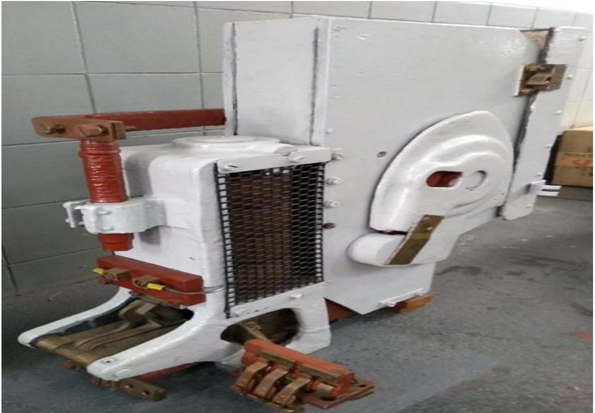
Figura 28: Disjuntor de linha utilizado nas automotrizes
