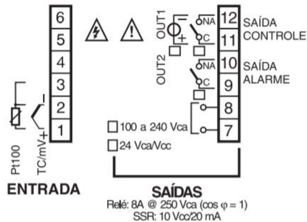
Figura 3 – Ligação do controlador de temperatura
