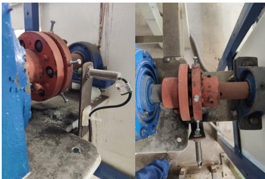
Figura 24.b: Conta Pulso com sensor indutivo
