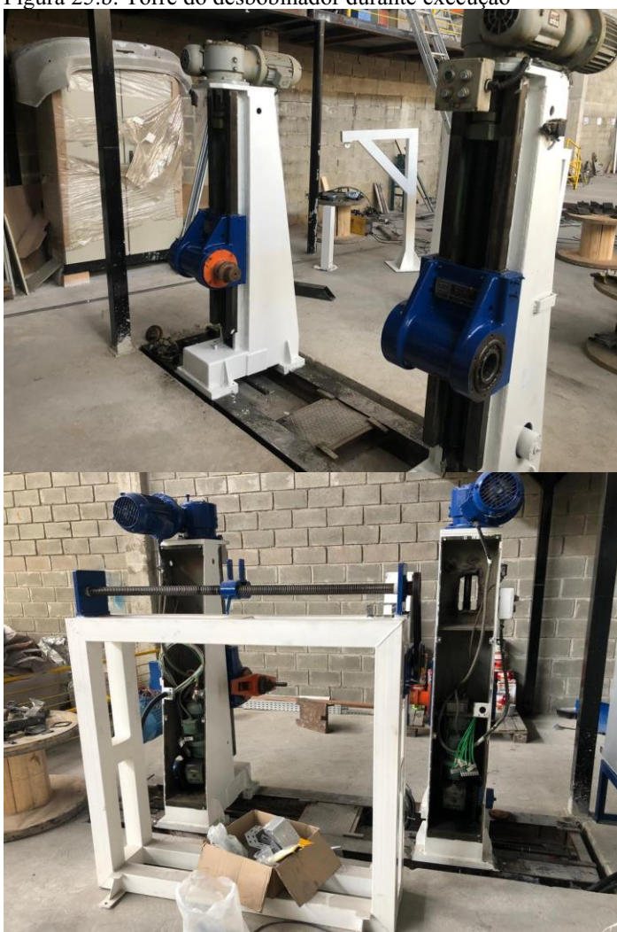
Figura 25.b: Torre do desbobinador durante execução
